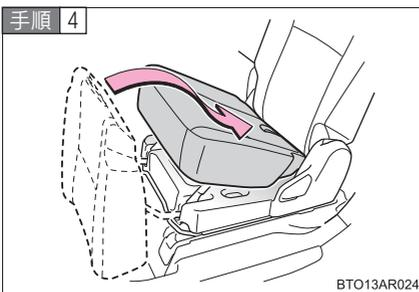
シートクッションの後端部を背もたれの下にもぐり込ませるようにして後方へ倒す
