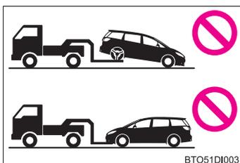
必ず前輪を持ち上げるか、4 輪とも持ち上げた状態で運搬してください。前輪が地面に着いた状態でけん引すると、駆動系部品が破損するおそれがあります。
