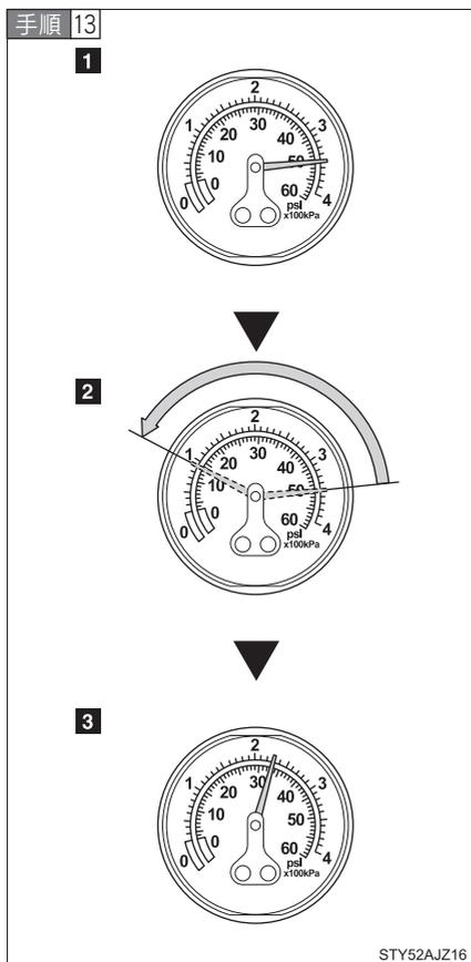
空気圧が指定空気圧になるまで空気を充填する
