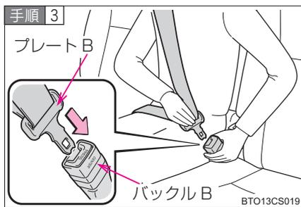
プレート B をバックル B に挿し込み、シートベルトを固定する
