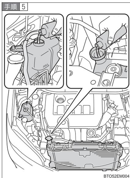
冷却水が不足している場合は、冷却水を補給する
