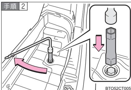
操作ボルトにエクステンションを取り付け、ホイールナットレンチで操作ボルトを締め付ける
