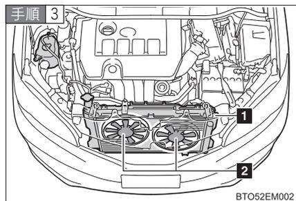
エンジンが十分に冷えてから、ラジエーターコア部（放熱部）やホースなどからの冷却水もれを点検する
