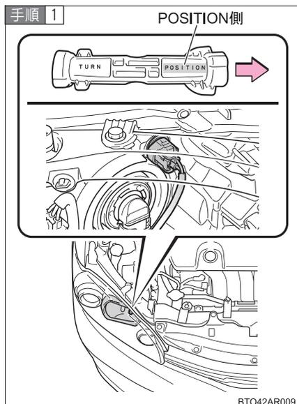
工具袋に収納されているバルブ交換ツール（→P. 314, 327）の“POSITION”側を車幅灯のソケットにはめ込む
