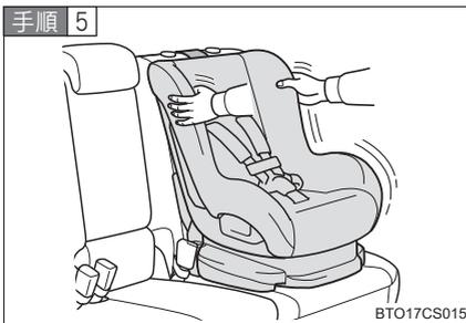
取り付けしたチャイルドシートを前後左右にゆすり、確実に取り付けられていることを確認する
