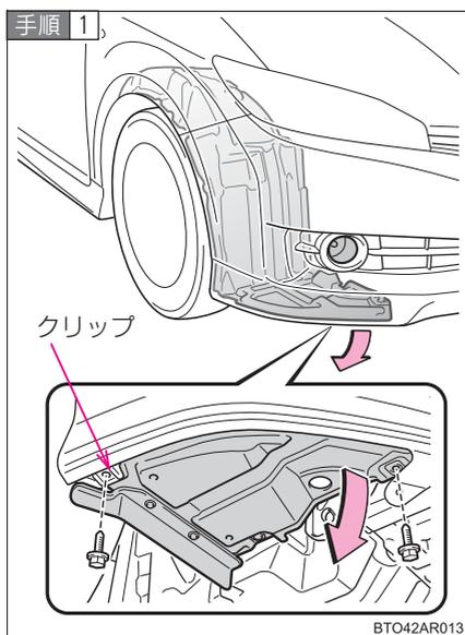
ボルトを取りはずし、クリップをずらしてフェンダーライナーをめくる
