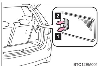
スイッチを ON にしておくとバックドアを開けたとき、ラゲージルームランプが点灯します。
