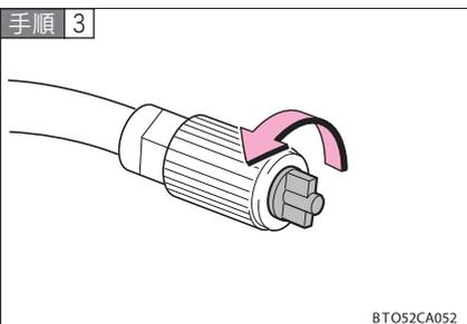
ボトルのホースから空気逃がしキャップを取りはずす
