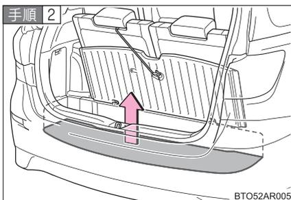
ラゲージルーム後部床上にあるマットの切り欠き部分をめくり、操作ボルトにエクステンションを取り付ける
