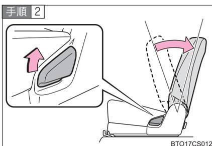
シートをいちばんうしろまで移動させたあと、チャイルドシートを取り付けやすいように、リクライニングレバーを引きながら、背もたれを後方に倒す
