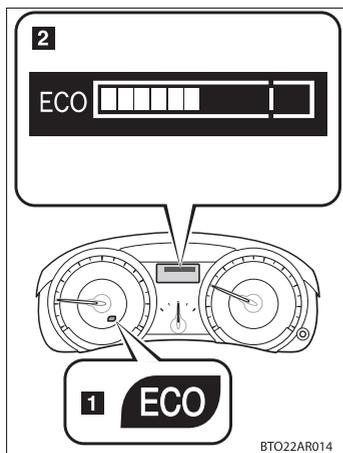
環境に配慮したアクセル操作（エコ運転）の範囲と、現状のアクセル開度を表示します。エコ運転中は、エコドライブインジケータランプ（**1**）が点灯します。
