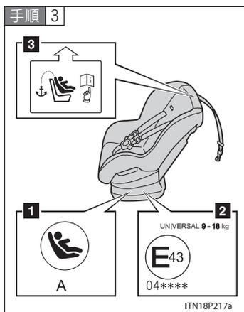
子供専用シートに表示されているマーク／ラベルを確認して、基準に適合したシートであることを確認する
