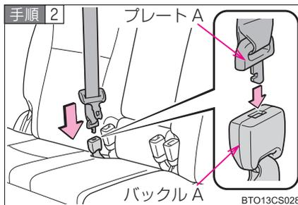
プレート A をバックル A に挿し込み、結合する
