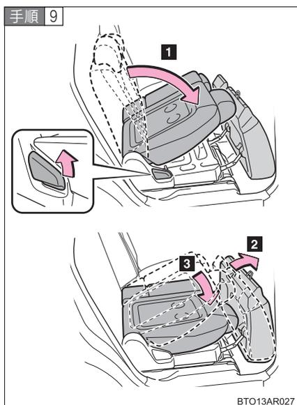
4WD 車の運転席側セカンドシートは、下記の手順に従って水平になるまで倒す
