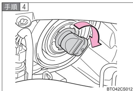
電球をまわして固定し、コネクターを取り付ける
