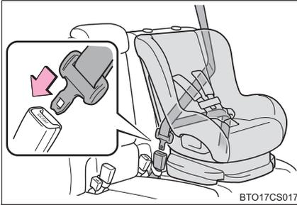
チャイルドシートにシートベルトを取り付け、プレートを保ックルに“カチッ”と音がするまで挿し込む。ベルトがねじれていないようにする
