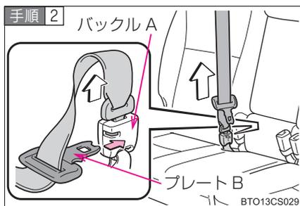
プレート B をバックル A に挿し込む
