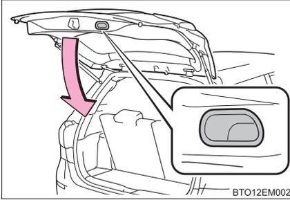
バックドアハンドルを持ってバックドアを引き下げ、必ず外から押して閉めてください。
