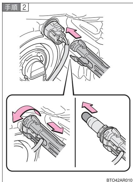
バルブ交換ツールをまわしてソケットを取りはずしたあと、電球を取りはずす
