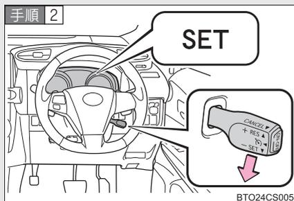
希望の速度まで加速 / 減速し、レバーを下げると速度を設定する
