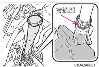
ウォッシャー液を補給する際は、インレットの接続部をこえる位置まで補給しないでください。接続部を超える位置までウォッシャー液を補給すると、接続部からウォッシャー液がもれることがあります。
