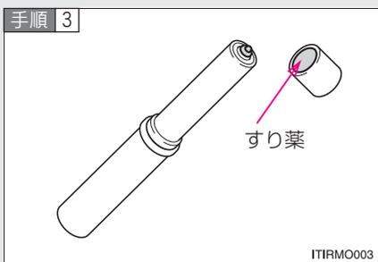
先端のフタをとり、すり薬で発炎筒の先端をこすり、着火させる
