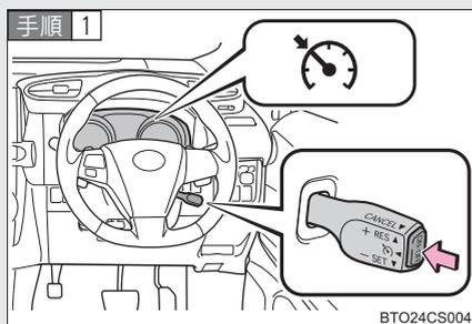
ON-OFF スイッチを押して、システムを ON にする
