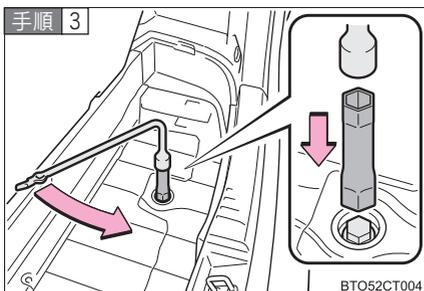
エクステンションにホイールナットレンチを取り付け、操作ボルトをまわしながら応急用タイヤが地面に着くまでゆるめる
