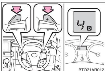
シフトレバーを D の位置で走行中、シフトパドルを操作することにより任意の変速段を選択することができます。この場合、シフトポジション・シフトレンジ表示灯に D が点灯し、変速段が表示されます。
