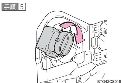
電球をまわして固定し、コネクターを取り付ける
