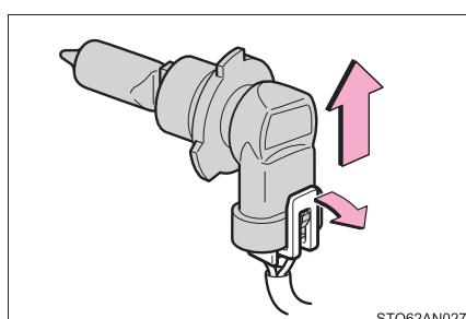
4 電球を交換し、コネクターを取り付ける
