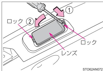
傷が付くのを防ぐため、ドライバーの先端にテープなどを巻いて保護してください。
