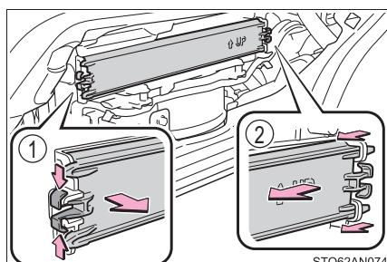
**5 フィルターを取りはずし、新しいフィルターと交換する**
