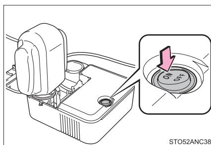
**[14] 空気圧が指定空気圧になるまで空気を充填する**
