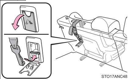
トップテザーアンカーにフックを固定し、テザーベルトを締める
