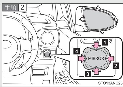
スイッチを操作してミラー鏡面を上下左右方向に調整する
