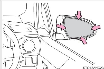
ミラー鏡面を手で押して角度を調整する
