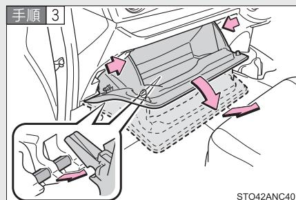
グローブボックス側面を内側に押して上部のツメを片側ずつはずし、下部のツメをはずして取りはずす
