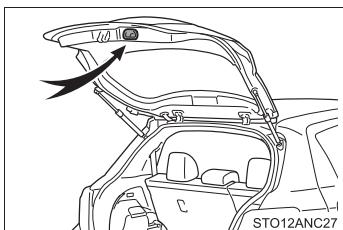
バックドアハンドルを持ってバックドアを引き下げ、必ず外から押して閉めてください。
