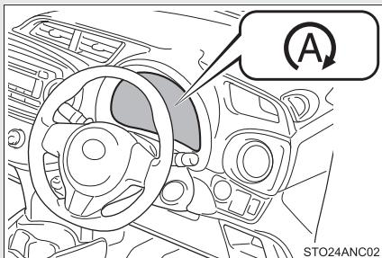
シフトレバーをDまたはSで走行中、ブレーキペダルを踏み車両を完全に停止させると、エンジンが自動的に停止する
