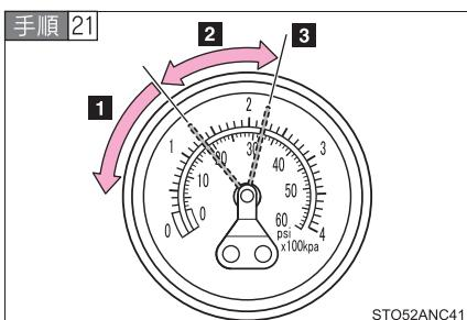
コンプレッサーのスイッチを約5秒間“ON”にし、“OFF”にしてから空気圧を確認する
