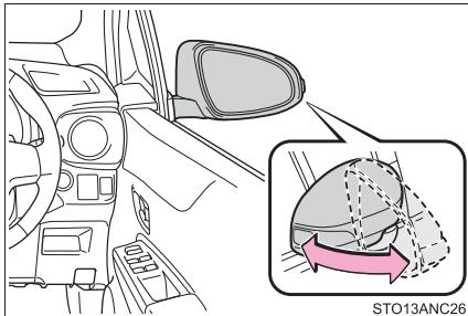
ドアミラーを手で後方に押して格納する
