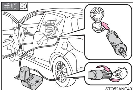
走行後、ボトルのホースから空気逃がしキャップを取りはずし、再度応急修理キットを接続する
