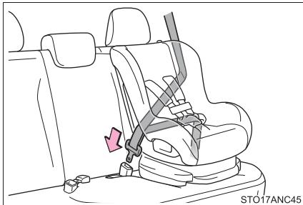
チャイルドシートにシートベルトを取り付け、プレートをバックルに“カチッ”と音がするまで挿し込む。ベルトがねじれていないうるようにする。
