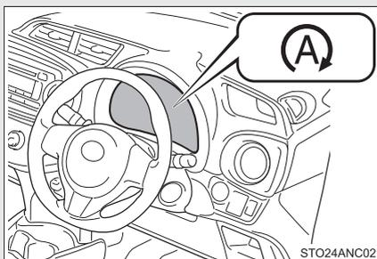
シフトレバーをDまたはSで走行中、ブレーキペダルを踏み車両を完全に停止させると、エンジンが自動的に停止する
