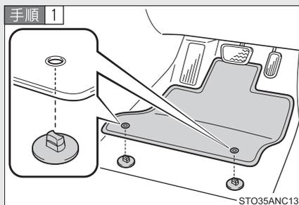
固定フック（クリップ）にフロアマット取り付け穴をはめ込む
