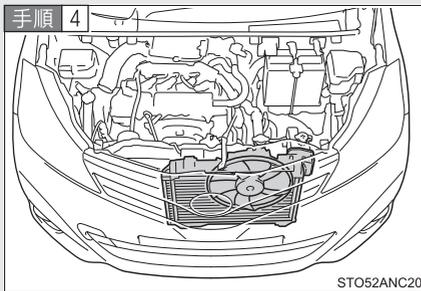
エンジンが十分に冷えてから、冷却水の量やラジエーターコア部（放熱部）の冷却水もれを点検する
