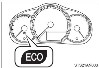
環境に配慮した運転をしているとき、エコドライブインジケーターステップランプが点灯します。必要以上にアクセルペダルを踏んだときや停車中は消灯します。
