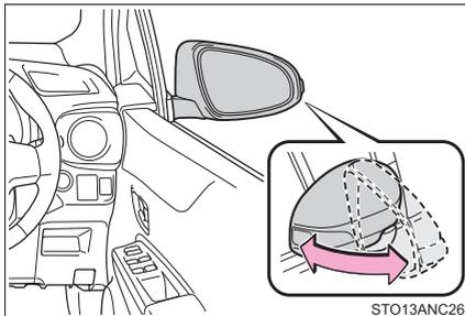
ドアミラーを手で後方に押し、格納する
