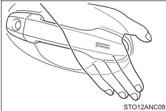
ドアハンドル表面のロックセンサーに指でふれても施錠できないときは、手のひらでロックセンサーにふれてください。
