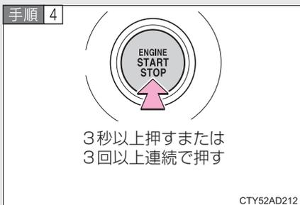
スマートエントリー&スタートシステム装着車：“エンジンスタートストップ”スイッチを3秒以上押し続けるか、素早く3回以上連続で押してエンジンを停止する。
