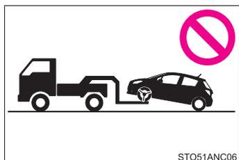
4輪とも持ち上げた状態で運搬してください。前輪または後輪だけ持ち上げたけん引は絶対にしないでください。駆動装置が焼き付きを起こしたり、車がトレッカー（台車）から飛び出すおそれがあります。
