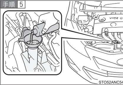
冷却水が不足している場合は、冷却水を補給する
