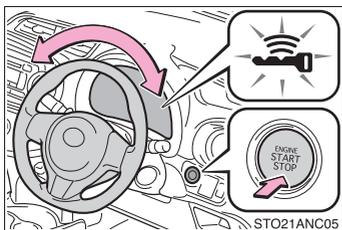
ステアリングロックが解除されていないときは、スマートエントリー&スタートシステム表示灯が 15 秒間緑色に速く点滅します。シフトレバーが P の位置にあることを確認して、ハンドルを左右にまわしながら再操作してください。
