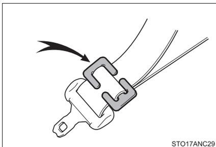
チャイルドシートにシートベルトの固定装置が備わっていない場合は、ロックングクリップ（別売）を使用して固定する。
