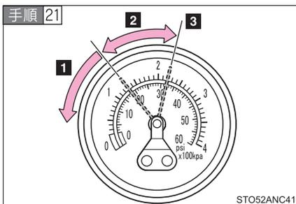
コンプレッサーのスイッチを約 5 秒間 “ON” にし、“OFF” にしてから空気圧を確認する
