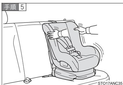
取り付けしたチャイルドシートを軽くゆさぶり、固定されていることを確認する
