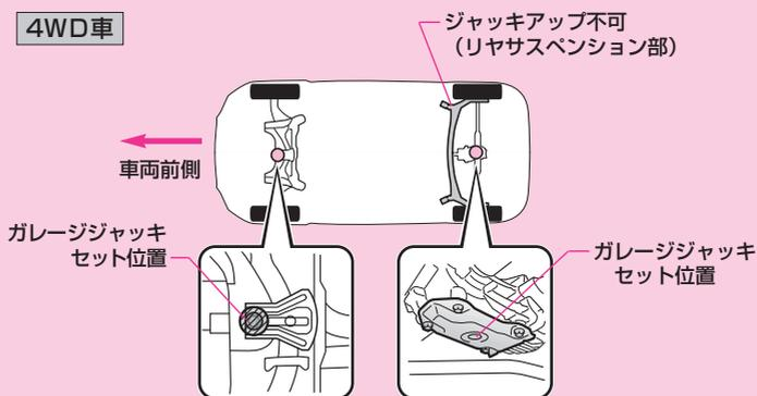
ガレージジャッキは、受皿の形状がガレージジャッキセット位置に適したサイズの受皿タイプを使用してください。
