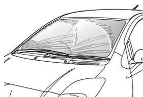
エンジンを始動し、ウインドウウォッシャーでガラスをぬらした状態でワイパーを作動させ、「間欠作動」「低速作動」「高速作動」「一時作動」の各作動が良いか、拭き取り状態が良いかを点検します。
