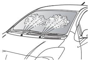
エンジンを始動し、ウインドウウォッシャーを作動させ、噴射の向きおよび高さがワイパーの作動範囲のほぼ中央にあたるかを点検します。
