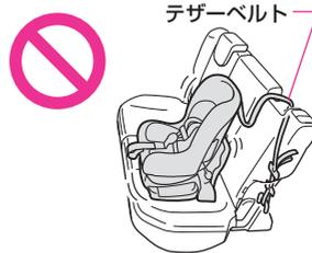
■ヘッドレストを上げた状態でチャイルドシート・ベビーシートを取り付けるときは、テザーベルトは必ずヘッドレストの下へ通してください。
