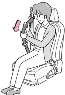
2 プレートをバックルに挿し込みます。
