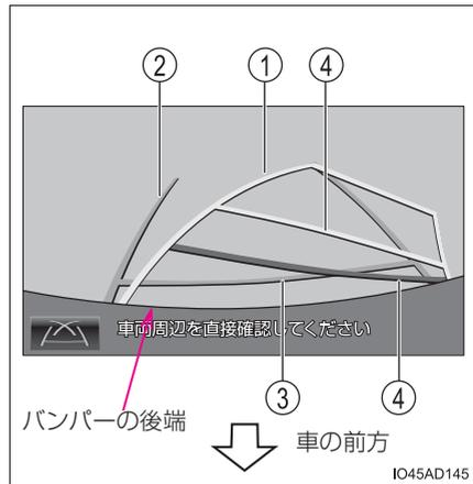
上の画面では、距離目安線が示す実際の距離（赤色：約 0.5m 先、黄色：約 1m 先）より、右側は近くの位置に、左側は遠くの位置に表示されます。
