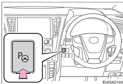
エンジンスイッチがイグニッション ON モード、シフトレバーが P、R 以外で車速が約 30km/h 以下のとき、IPA スイッチを押すごとに、次のように機能が切りかわります。
