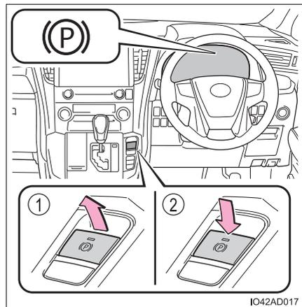
パーキングブレーキ表示灯が点滅した場合は、再度スイッチを操作してください。(→ P. 634)
