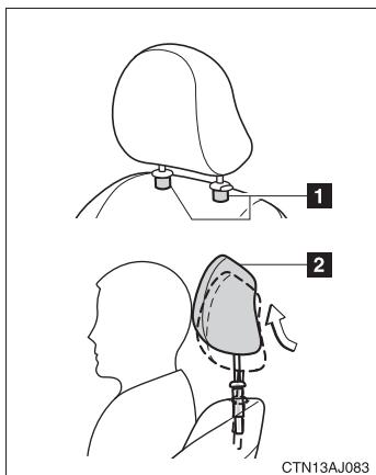
シートバックへの衝撃が弱い場合でもアクティブヘッドラストが作動することがあります。なお、解除ボタンを押さずにヘッドラストを無理に押し上げると、ヘッドラストの構造部品が出てきますが、故障ではありません。
