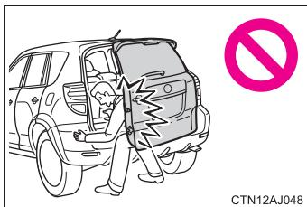
● 半開状態で使用すると、バックドアが閉じて重大な傷害を受けるおそれがあります。とくに傾斜地では、平坦な場所よりもバックドアの開閉がしにくく、急にバックドアが開いたり閉じたりするおそれがあります。必ずバックドアが全開で静止していることを確認して使用してください。
