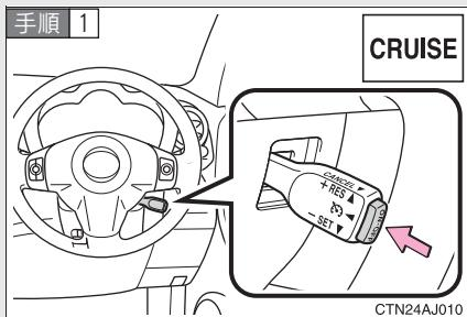
ON-OFFスイッチでシステムをONにする
