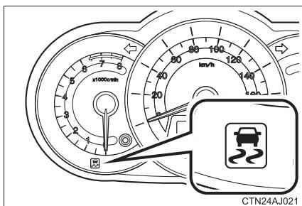
ダウンヒルアシストコントロールシステムが作動しているときは、スリップ表示灯が点滅します。このとき、制動灯とハイマウントトップライトが点灯しています。
