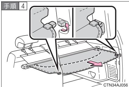
トノカバーを引き出し、カバー両側のフックを車両後方の左右の取りつけ部に差し込む。
