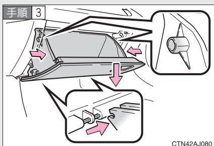
グローブボックス側面を内側に押して上部のツメを片側ずつははずし、下部のツメをはずして取りはずす。
