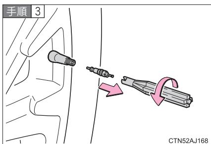
バルブコア回してバルブコアを反時計回りにまわして抜き取る。
