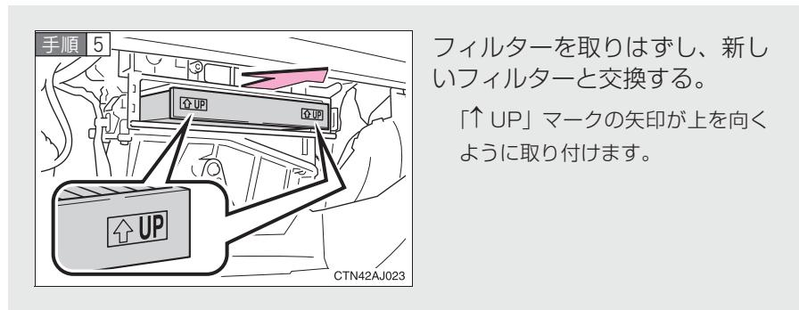
フィルターを取りはずし、新しいフィルターと交換する。
