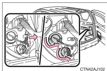
カバーをはずした後、ツメから配線をはずしてから、ソケットを取りはずします。
