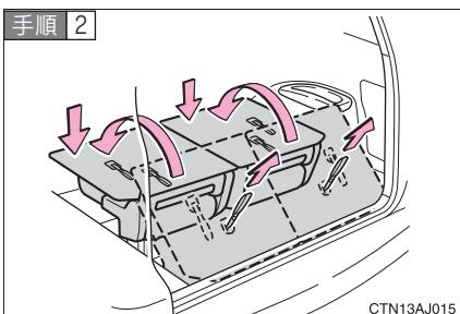
ストラップを引きながら、シート全体を前方へ押し出し、シート全体を押し下げてロックさせる。
