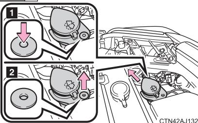
クリップをはずしウォッシャー液補給口の位置を移動する。
