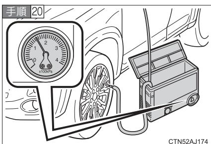
圧力計で空気圧を確認する。
