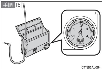
圧力計を確認しながら指定空気圧になつたらコンプレッサーのスイッチを OFF にする。
