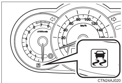
車両が横すべりしそうになったとき、駆動輪が空転したときは、S-VSC、TRC の作動を表示するために入リップ表示灯が点滅します。
