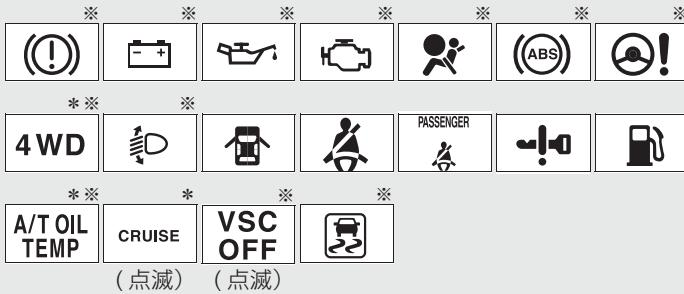
\*作動確認のために“エンジンスタートストップ”スイッチをイグニッションONモードにすると点灯し、数秒後またはエンジンをかけると消灯します。
