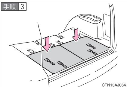
シートの前側を押し下げてロックさせる。
