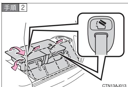
ストラップを引きながら、シート全体を車両後方へ引き上げる。
