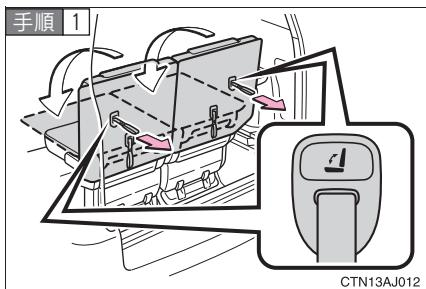
ストラップを引きながら、背もたれを前方に倒しロックさせる。
