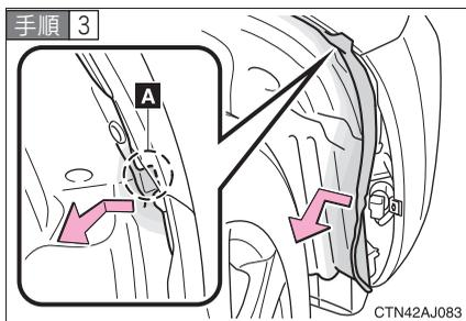
A 部を車両内側へ押しフェンダーライナーをフェンダーからはずし、フロントフォグライトのコネクターが見える位置までフェンダーライナーをめくる。
