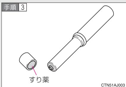
先端のふたを取りはずし、すり薬と発炎筒の先端をこすり、着火させる。
