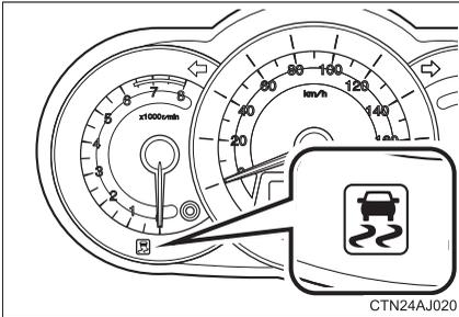
車両が横すべりしそうなとき、駆動輪が空転したときは、S-VSC、TRC の作動を表示するためにスリップ表示灯が点滅します。
