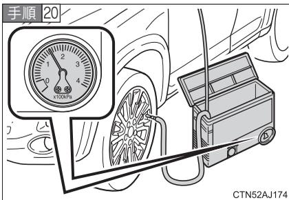
圧力計で空気圧を確認する。
