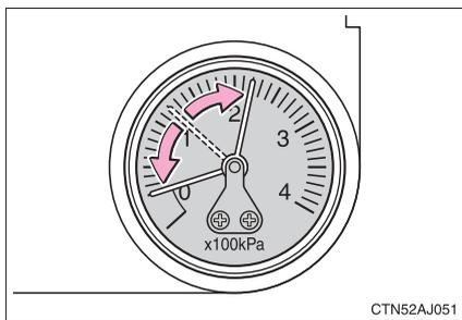
空気圧が 130 kPa 以上の場合は、指定空気圧まで空気を充填する。
