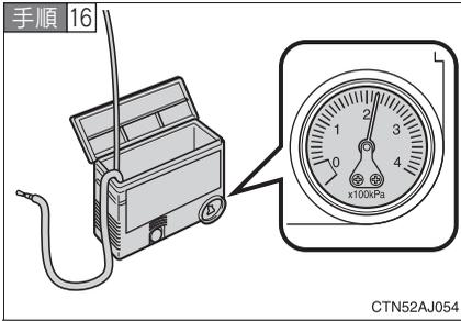
圧力計を確認しながら指定空気圧になったらコンプレッサーのスイッチを OFF にする。
