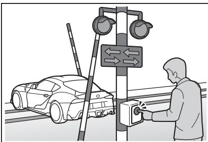
同乗者や付近の人に応援を求めて安全な場所まで車を押してもらいます。車を移動できないときは、ただちに乗員を安全な場所へ避難させます。踏切警報機に設置してある非常ボタンを押すか、発炎筒を点火して、近づいてくる列車に踏切内で車が止まっていることを知らせます。発炎筒を使用するときは、製品に記載されている取扱方法に従い、点火した発炎筒を高く持ちながら、踏切から列車が来る方向に数百メートル移動して列車に知らせてください。
