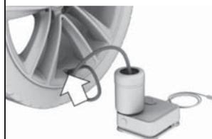
5 コンプレッサーをオフにした状態で、コネクターを車内の電源ソケットに差し込みます。
