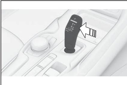
セレクター レバーをセレクター レバー ポジション D から出して、左に押します。
