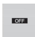
メーターパネルにOFFが表示されます。ドライブトレインがオフで、作動スタンバイがオンの状態です。
