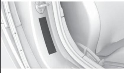
タイヤ空気圧規定値はドア ピラーのタイヤ空気圧ラベルに記されています。
