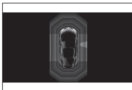
車両のサイド部を保護するために、車両の横側に障害物マークが表示されます。
