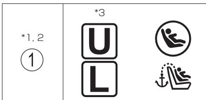
**U** 車両のシートベルトで固定するタイプのユニバーサル（汎用）カテゴリーのチャイルドシートに適しています。
