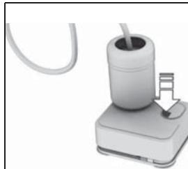
コンプレッサーを最長 10 分間作動させて、シール剤が充填され、タイヤ空気圧が約 2.0 バールに達するようにします。
