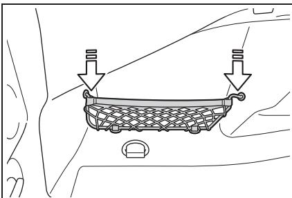
小物は左側のネットに収納できます。比較的大きな物を運ぶ場合は、ネットを下方に移動します。そのために、ネットの端をできる限り縁の側、ホルダー脇でつかみます。抵抗に逆らって動かすとスタートします。
