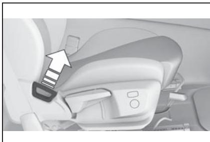
レバーを引き、必要に応じてバック レストに力を加えるか、力を抜くようにします。
