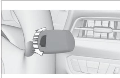
レイン センサーの感度を調節するにはダイヤルを回します。
