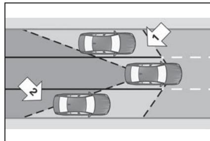
最低速度以上になると、リア バンパー内にある 2 個のレーダー センサーが車両の後方および横の空間をモニターします。
