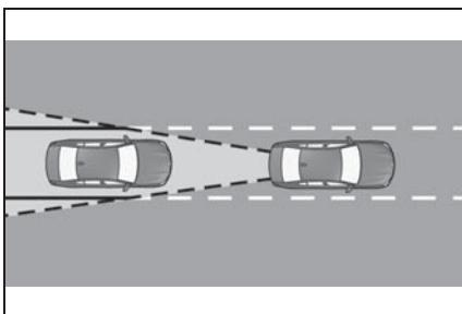
リア バンパー内にある 2 個のレーダー センサーが車両後方の空間をモニターします。
