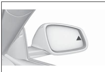
リアセンサーによって車両が検知され、自車が後進すると、ドアミラーのランプが点滅します。
