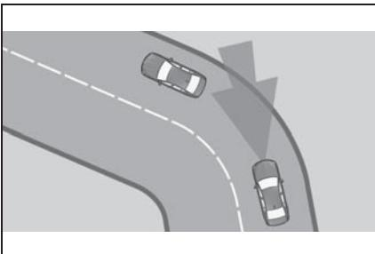
カーブに対して設定速度が高すぎる場合、カーブ走行時の速度が少し減速しますが、カーブは前もって検知されません。そのため、適切な速度でカーブに入ってください。
