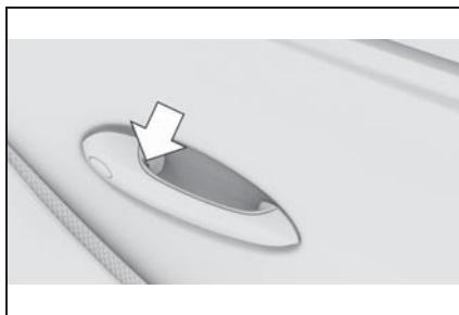
ドアが閉まっている状態で、ドアハンドルの溝の部分に指で約1秒間触れます。
