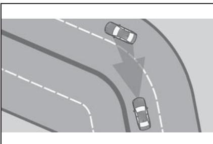
カーブにさしかかったとき、カーブの大きさによっては、一時的にシステムが隣の車線の車両に反応する場合があります。このようなときは、短時間加速することで車両の減速を補整することができます。アクセルペダルをはなすと、システムは再び作動状態となり速度を自動制御します。
