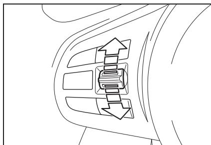
希望の速度リミットが設定されるまで、タンブラー スイッチを何度か上か下に押してください。
