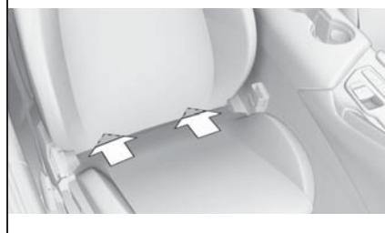
ISOFIX 下部アンカー用のマウントは、シートとバック レストの間の隙間にあります。
