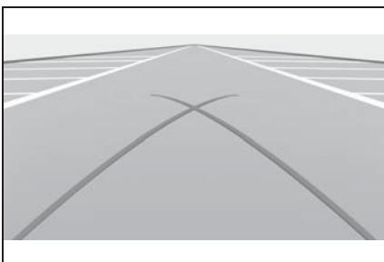
旋回予想線は車幅確認線と一緒にのみ、カメラの画像の中に表示させることができます。
