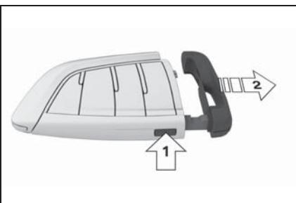
ボタン、矢印 1、を押し、内蔵キーを引き抜きます、矢印 2。
