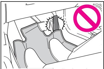
フロアマットは、この車両専用のトヨタ純正品のみを使用し、付属の固定具で確実に固定してください。清掃等でフロアマットを脱着後も、固定具で確実に固定してから運転をしてください。
