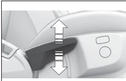
シートが希望の高さになるまで、レバーを何度も上に引くか、下に押します。
