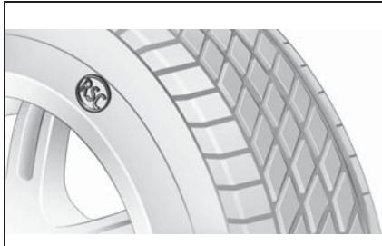
タイヤ側面部分に RSC-Runflat SystemComponent と刻印されています。
