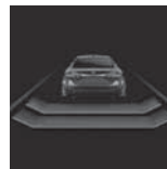
シンボルが緑色： 前走車が検知されています。システムは設定された前走車との車間距離を維持します。
