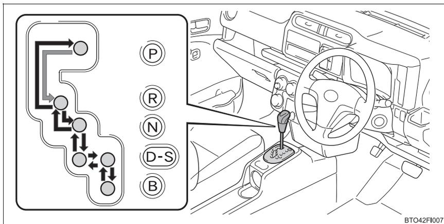
← エンジンスイッチが“ON”の状態、ブレーキペダルを踏んだまま操作します。
