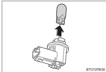
5 新しい電球を取り付け、ソケットを取り付ける
