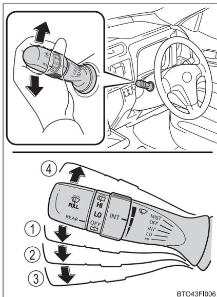
間欠作動（INT）を選択しているとき、間欠時間を調整することができます。（間欠時間調整式ワイパー装着車）
