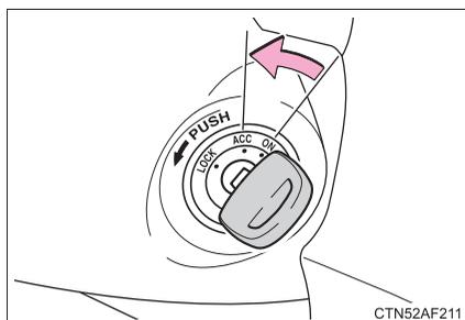
スマートエントリー&スタートシステム装着車：エンジン スイッチを3秒以上押し続けるか、素早く3回以上連続で押してエンジンを停止する
