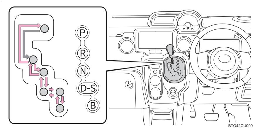
← エンジン スイッチが“ON” ★またはイグニッション ON モード★の状態、ブレーキペダルを踏んだまま操作します。
