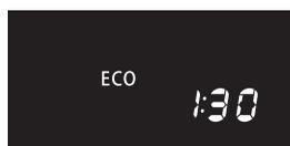
エンジン スイッチを“ON”★から“LOCK”★、またはイグニッション ON モード★から OFF★にするまでのアイドリングストップ時間 (Stop & Start システムによるエンジン停止時間) を通算で表示します。
