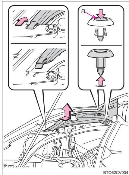
**電球交換のしかた****■ ヘッドランプロービーム（ハロゲンヘッドランプ装着車）**
