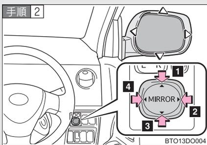
スイッチを操作してミラーを上下左右方向に調整する。
