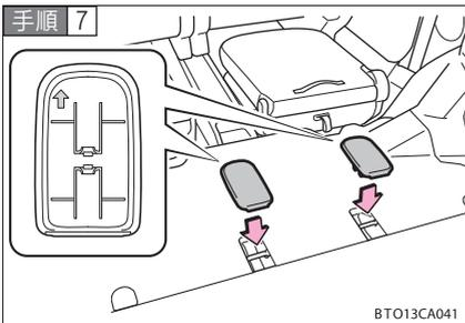
ラゲージスペースのシート固定部に保護カバーを取り付ける。
