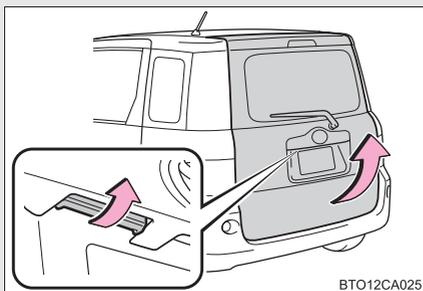
バックドアハンドルを押したまま、バックドアを持ち上げる
