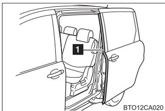
パワースライドドア前端部のセンサー(1)を刃物などの鋭利なもので傷付けないように注意してください。センサーが切断されると自動で閉めることができなくなります。また、自動で閉めているときにセンサーが切断されると、ドアはただちに停止します。
