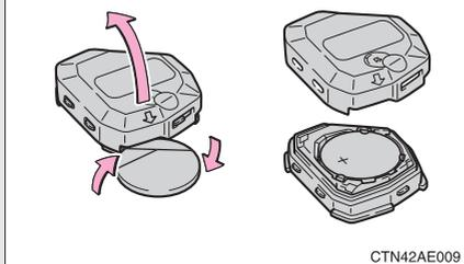
コインなどを使って、モジュールカバーをはずし消耗した電池を取り出す。
