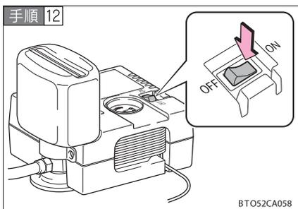
コンプレッサーのスイッチを ON にし、パンク補修液と空気を充填する。
