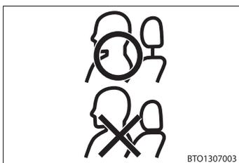
使用するときには、常に格納位置（ヘッドレストが最も下がった位置）から“カチッ”と音がするまで上げた位置にしてください。また、ヘッドレストを押し下げ、確実に固定されていることを確認してください。
