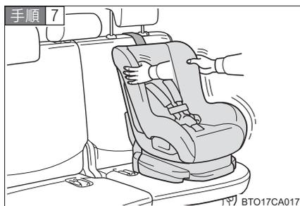
取り付けしたチャイルドシートを軽くゆさぶり、固定されていることを確認する。
