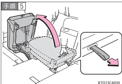
シートロック解除ストラップを引いてロックを解除し、グリップを握りサードシート後端を垂直になるまで引き起こす。
