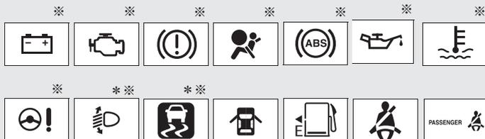
※作動確認のためにエンジン スイッチを “ ON ” にすると点灯し、数秒後またはエンジンをかけると消灯します。
