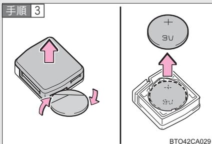
コインなどを使って、モジュールカバーをはずし消耗した電池を取り出す。
