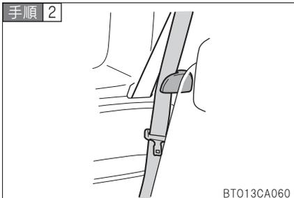
サードシートのシートベルトをベルトハンガーに取り付ける。
