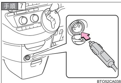
コンプレッサーの電源プラグをアクセサリーソケットに挿し込む。
