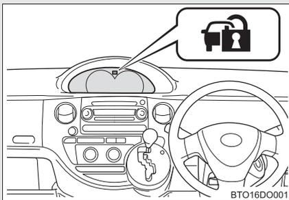
エンジンスイッチを“LOCK”にすると、システムの作動を知らせるためにインジケーターが点滅します。
