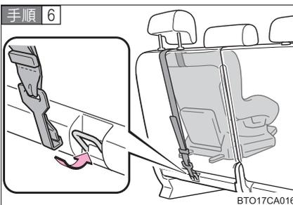
トップテザーアンカーにフックを固定し、テザーベルトを締める。
