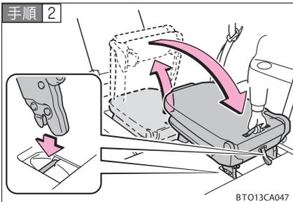
サードシートのグリップを握り、サードシートの後端を持ち上げ、シート固定位置まで引き上げる。
