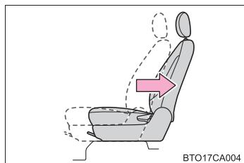
やむを得ず助手席に子供専用シートを取り付ける場合には、助手席シートをいちばんうしろに下げ、背もたれを直立状態にし、子供専用シートを前向きに取り付けてください。
