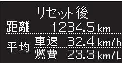
リセットしてからの通算の走行距離と平均燃費と平均車速を表示します。
