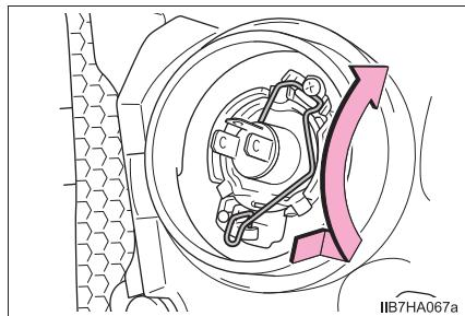
**8** 電球を取りはずす
