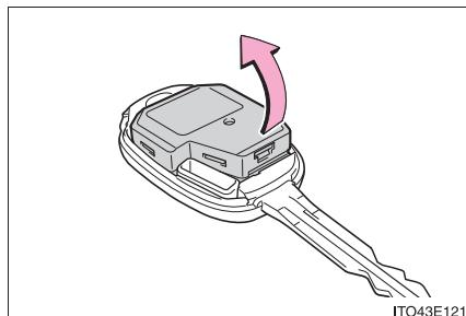
**3** コインなどを使用してモジュールカバーをはずし、消耗した電池を取り出す
