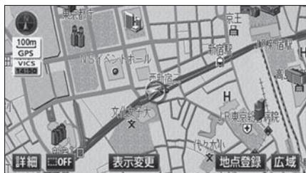
3個以上のGPS衛星からの電波を受信して、自転車の現在地を測定することです。本機では3個以上のGPS衛星の電波を受信して測位可能な場合に、現在地画面上の左上隅に「GPS」を表示します。（メニュー画面、設定や登録の画面では、「GPS」は表示しません。）
