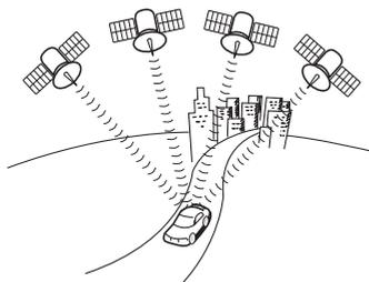
GPSは、高度約21000kmの軌道上を周回する通常4個以上、場合により3個のGPS衛星から地上に放射される電波を受信して、現在の位置（緯度、経度、高度）を知ることができるシステムです。
