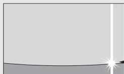
※スミヤ現象：高輝度の点（車体に反射した太陽等）がカメラに映るとその点の上下（縦方向）に尾を引く現象。
