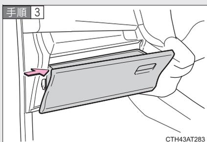
グローブボックス車両外側面を内側に押し、上部のツメをはずす
