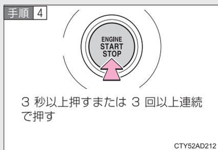
スマートエントリー&スタートシステム装着車：“エンジン スタート ストップ” スイッチを 3 秒以上押し続けるか、素早く 3 回以上連続で押してエンジンを停止する。
