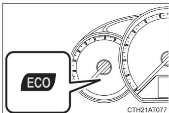
エコドライブインジケータランプが点灯すると、環境に配慮した運転をしていることを知らせます。必要以上にアクセルペダルを踏むと消灯します。
