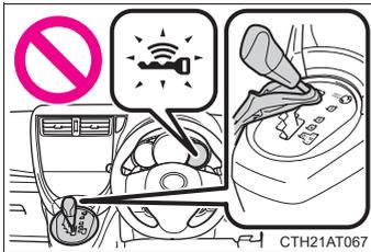
シフトレバーが P の位置にあるか確認してください。エンジンを始動するときに、シフトレバーが傾いたり、P 以外の位置にするとステアリングロック機能が作動しエンジンを始動することができません。スマートエントリー & スタートシステム表示灯が緑色に速く点滅します。
