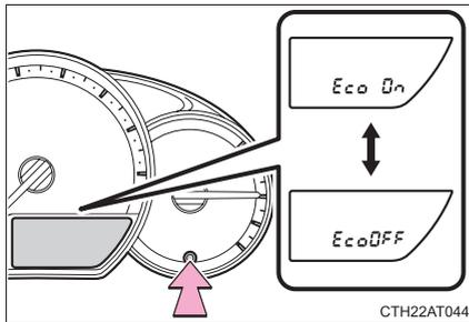
エコドライブインジケータランプの点灯／消灯を変更するには、エコドライブインジケータランプユーザーカスタマイズ画面表示中に、表示切りかえボタンを押します。
