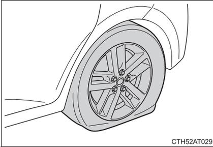
応急修理をする前に、タイヤ損傷の程度を確認する
