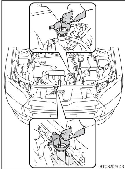
冷却水がない場合は、応急措置として水を補給してください。
