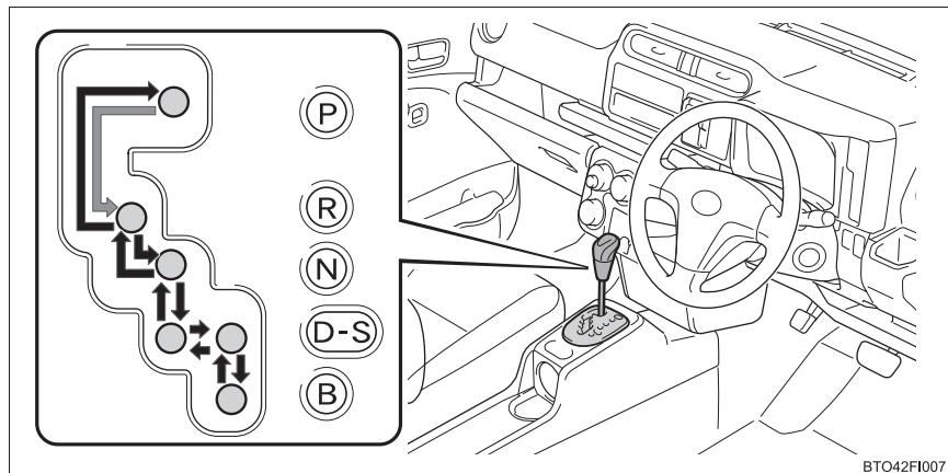
← エンジンスイッチが“ON”の状態で、ブレーキペダルを踏んだまま操作します。
