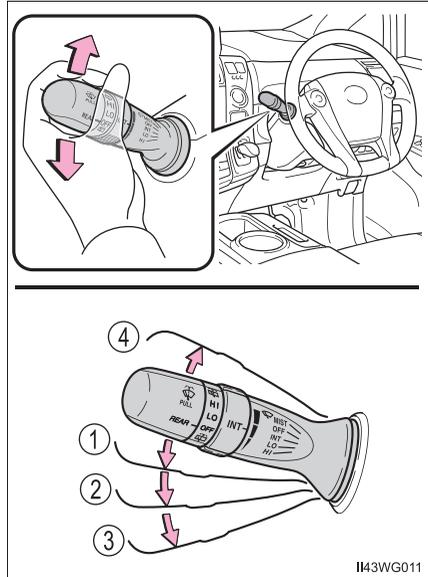
間欠作動を選択しているとき、間欠時間を調整することができます。
