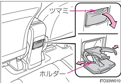
ツマミを引いてフタを開け、ホルダーを調整して使用する
