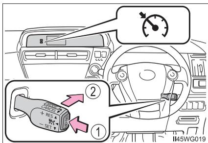
定速制御モードに切りかえると、クルーズコントロール表示灯が点灯します。
