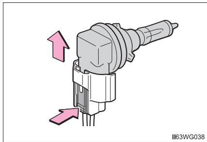
3 電球を交換し、ソケットを取り付ける
