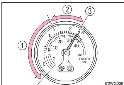
**22** コンプレッサーのスイッチをONにして指定空気圧まで空気を充填し、再度約 5km 走行後にあらためて**20**から実施する
