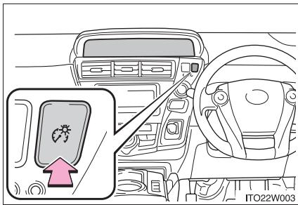
車幅灯が点灯中で、かつ周囲が暗いとき、スイッチを押すたびに、メーター表示の明るさが切りかわります。
