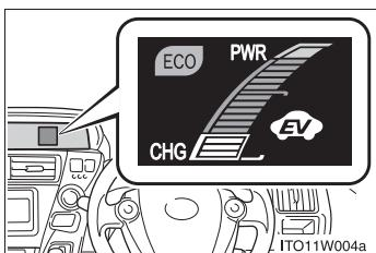
ハイブリッドシステムの作動状況に応じて、インジケーターの表示が変化します。
