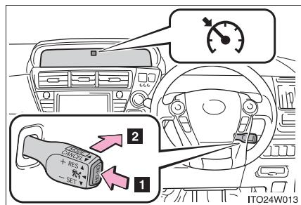
**1** “ON-OFF”スイッチを押して、システムを ON にする
