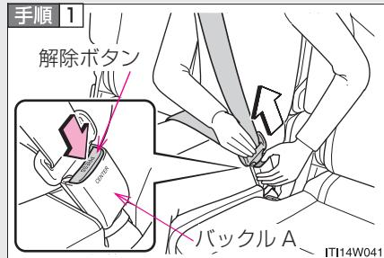
バックルA の解除ボタンを押して、ベルトを解除する
