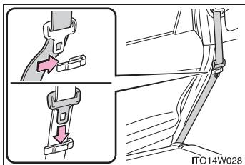
左右席のシートベルトを使用しないときは、シートベルトハンガーに格納することができます。
