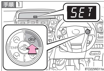
DISP スイッチを押してドライブモニターにセッティング画面を表示させたあと、DISP スイッチを 1 秒以上押し続ける
