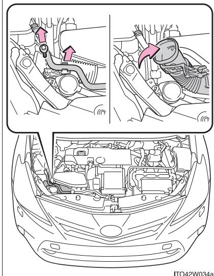
運転席側を交換するときは、ネジ（1本）を取りはずしてラジエーターリザーバータンクのホースのステーをはずし、エアクリーナーの吸入口を持ち上げる
