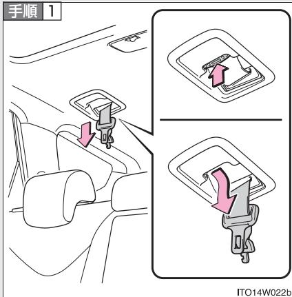
図の部分を押して固定をはずし、シートベルトを引き出す
