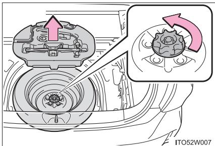
ツールホルダーを車両から降ろし、留め具を取りはずして応急用タイヤを取り出す
