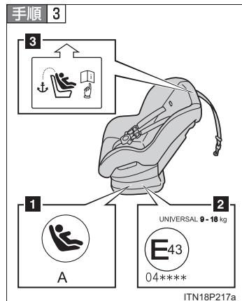
子供専用シートに表示されているマーク／ラベルを確認して、基準に適合したシートであることを確認する
