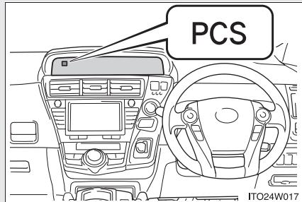
衝突の可能性が高いと検知したとき、“ピピピ・・・”とブザー音が鳴り、PCS 警告灯が点滅し、回避操作をうながします。
