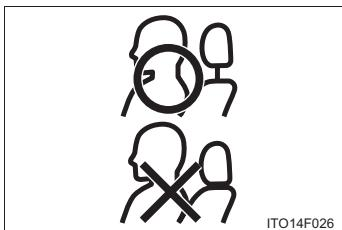
使用するときは、常に格納位置（ヘッドレストが最も下がった位置）から“カチッ”と音がするまで上げた位置にしてください。また、ヘッドレストを押し下げ、確実に固定されていることを確認してください。
