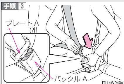
“カチッ”と音がするまでプレートAをバックルAに挿し込み、ベルトを固定する
