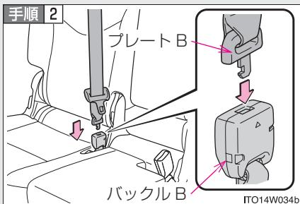
“カチッ”と音がするまでプレートBをバックルBに挿し込み、結合する
