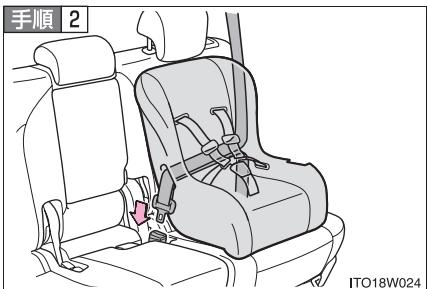
チャイルドシートにシートベルトを取り付け※、プレートをバックルに“カチッ”と音がするまで挿し込む。ベルトがねじれていよいうにする
