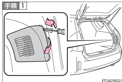
バックドアを開けて、図の位置にある切り欠きにマイナスドライバーを挿し込んで、カバーをはずす
