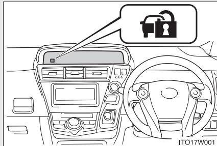
“パワー”スイッチを OFF になると、システムの作動を知らせるためにインジケーターが点滅します。
