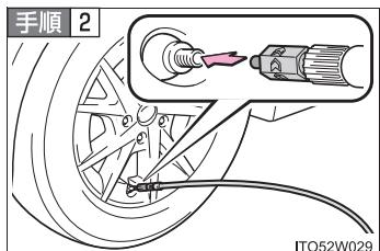
ボトルのホース先端に空気逃がしキャップを取り付け、キャップの突起部をタイヤのバルブに押しあて、空気を抜く
