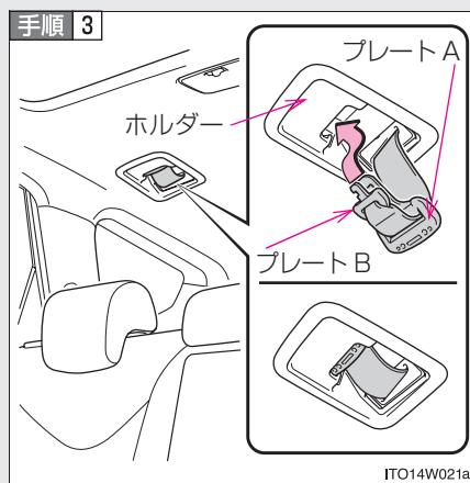
プレートA、Bを重ねて、ホルダーに挿し込む
