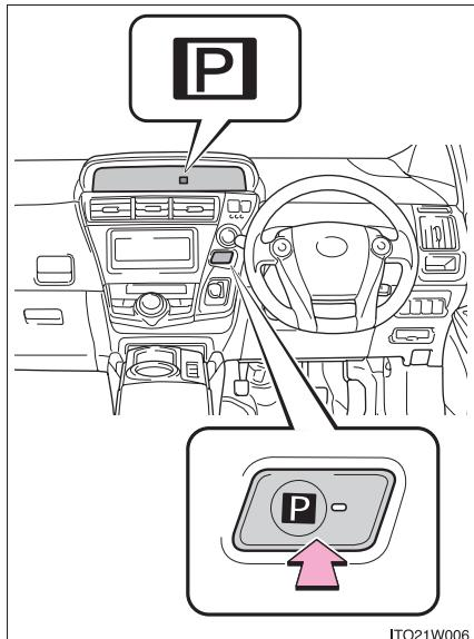
車を完全に停止させ、パーキングブレーキをかけ、P ポジションスイッチを押す
