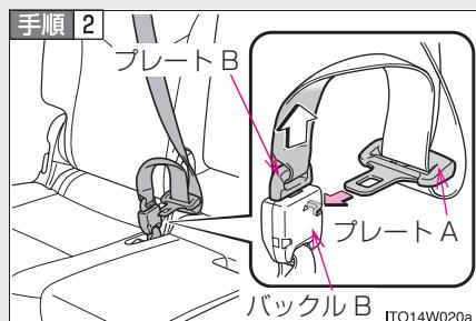
プレートAなどでバックルBのボタンを押し、プレートBを分離する
