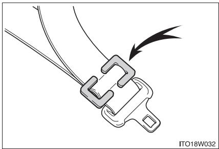
チャイルドシートにシートベルトの固定装置が備わっていない場合は、ロッキングクリップ(別売)を使用して固定する
