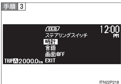
設定変更を行う項目を選択し、DISP スイッチを押し続ける
