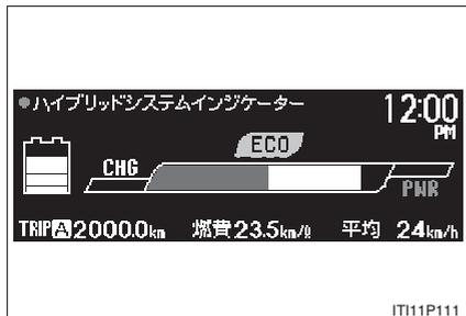
車両の走行状況に対するハイブリッドシステムの作動状況がバー表示で示されます。
