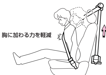
【衝突時規定荷重を維持しながらシートベルトを引き出す】
