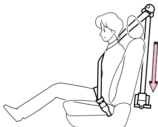
【衝突初期にシートベルトを瞬時に巻き取る】
