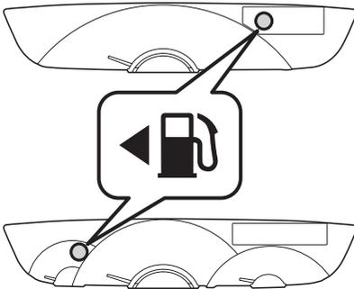
メーター内にフューエルリッドの車両取り付け方向を示しています。
