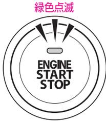
エンジンの始動操作をしたときに、ハンドルロックが解除できないと、エンジンスイッチの表示灯が緑色に点滅します。
