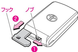
電子カードキーのノブを(1)の方向にスライドさせたまま、エマージェンシーキーのフック部(2)を引いて取り出します。
