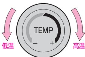
ダイヤルを左右に回して、設定温度を調整します。
