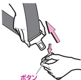
バックルのボタンを押します。ベルトは自動的に収納されますので、ねじれや引っかかりなどがなければ確認しながら、プレートに手を添えてゆっくり戻します。
