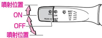
リヤワイパー作動中にウォッシャー液を噴射させるときは、ツマミを“ON” の位置から上側の“ウォッシャー液噴射位置”に回します。
