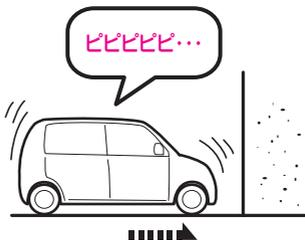
車速が約 4km/h 以下で、アクセルペダルが必要以上に踏み込まれたと判断したときに、ブザー音とメーター表示で警報し、運転者に衝突回避操作を促します。
