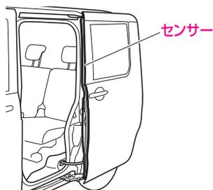
パワースライドドアの自動開閉作動中に、挟み込みを検知したドアを少し反転作動した後に途中で停止させる機構です。
