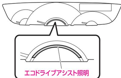
ILL On (または ILL OFF) を表示させて、ODO/TRIP スイッチを約 1 秒以上押し続けるごとに、“ILL On”、“ILL OFF” が切り替わります。
