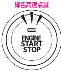
エンジンの始動操作をしたときに、ハンドルロックが解除できないと、エンジンスイッチの表示灯が緑色に高速点滅します。
