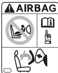
助手席にベビーシートを取り付けたり、チャイルドシートを後ろ向きに取り付けしないでください。衝突時などに生命にかかわる重大な傷害におよぶか、最悪の場合死亡につながるおそれがあります。
