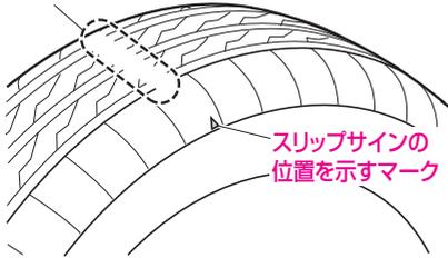
タイヤの溝の深さに不足がないかをスリップサイン（摩耗限度表示）により点検してください。
