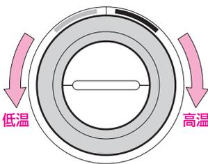
ダイヤルを左右に回して、設定温度を調整します。
