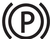
エンジンスイッチが“ON”で、駐車ブレーキがかかっていると点灯し、駐車ブレーキを完全に解除すると消灯します。
