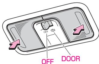
フロントパーソナルランプのレンズを押すと、スイッチの位置、ドアの開閉に関係なく点灯します。
