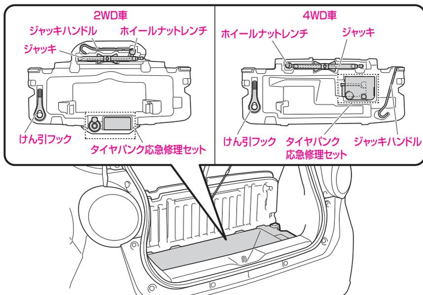
ジャッキ、工具、タイヤパンク応急修理セットは、ラゲージルーム内のラゲージアンダーボックスに収納しています。
