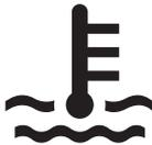
エンジンスイッチが“ON”で、エンジン冷却水温が低いとき、青色に点灯します。
