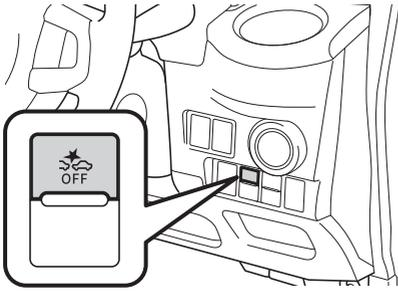
エンジンスイッチが“ON”のとき、スマートアシスト OFF スイッチを操作することで、スマートアシストⅢの次の機能を停止することができます。
