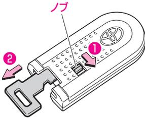
電子カードキーのノブを(1)の方向にスライドさせたまま、エマージェンシーキーを(2)の方向に引いて取り出します。
