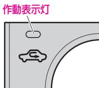
スイッチを押して内気循環、外気導入を切り替えます。
