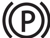
エンジンスイッチが“ON”で、駐車ブレーキがかかっていると点灯し、駐車ブレーキを完全に解除すると消灯します。
