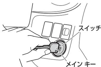
4. キーの認識後、約 4 秒以内にスイッチを押すと、エンジンが始動します。
