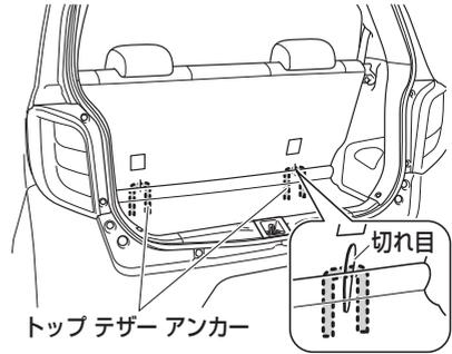
2. 適合するチャイルド シートの取り付け金具をISO FIX対応チャイルド シート固定バー & トップ テザー アンカーに連結して取り付けます。(取り付け方法は、商品に付属の取扱説明書をよく読んでください。)
