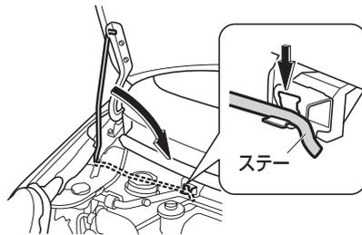
2. ボンネットを静かに下げ、手で押さえるようにして閉めます。
