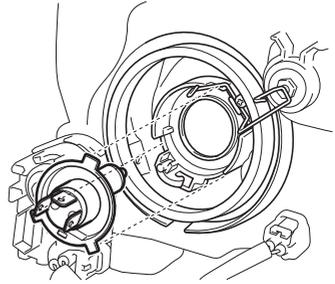
2. クリップを確実にフックに取り付け、バルブを固定します。
