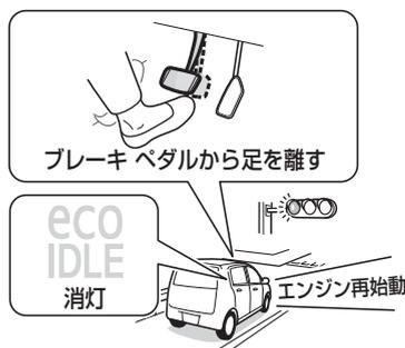
4. しばらく走行して、再びアイドリング ストップする条件を満たすと、eco IDLE表示灯が緑色に点灯します。
