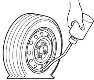
7. 注入し終わったら、注入ホースをタイヤ バルブから引き抜き、バルブ コア（ムシ）をタイヤ バルブにしっかりとねじ込みます。
