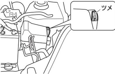
3. カバーを傾けた状態で、矢印の方向に押し込んだあと、手前に抜き取ります。
