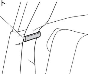
2. 車両後側から左右両側のシート バック フックを同時に操作して、背もたれを前に倒します。
