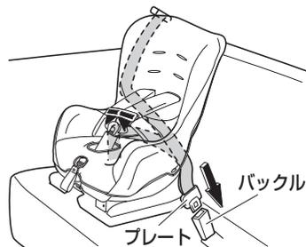
3. バックルの中にプレートを「カチッ」と音がするまで差し込みます。
