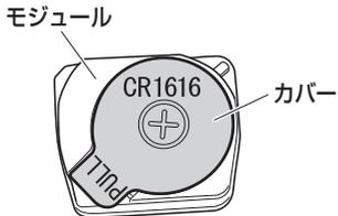
3. 矢印の方向にスライドさせて、電池を取り出し、新しい電池と交換します。
