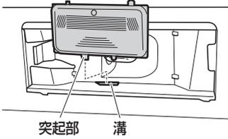
3. レンズを矢印の方向に押し付けて取り付け、確実に固定されたことを確認します。
