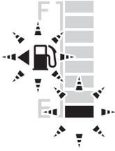
電源が“ON”のとき、燃料残量が2WD車は約6ℓ、4WD車は約5.5ℓ以下になると、燃料計の一番下の目盛りと燃料残量警告灯が点滅し、さらに燃料が少なくなると点滅が速くなります。
