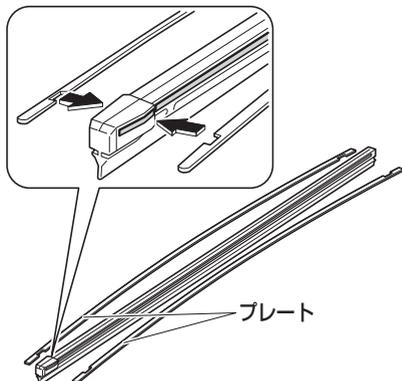
4. ストッパーがない側からラバーをブレードに挿入します。
