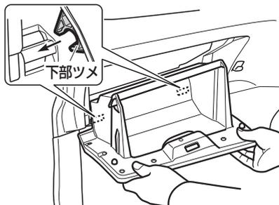
2. グローブボックスを矢印の方向に押し込みます。
