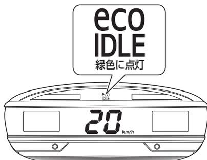
2. ④レンジのままブレーキ ペダルを踏み減速すると、停車前（約7km/h）もしくは停車後に、アイドリング ストップします。
