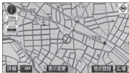
●道路形状警告表示
