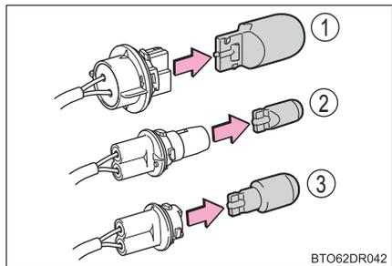
4 電球を取り付け、ソケットをまわして取り付ける
