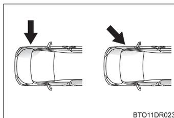
SRS サイド&カーテンシールドエアバッグは、後方からの衝撃・横転・または低速での側面からの衝撃で作動するようには設計されていません。
