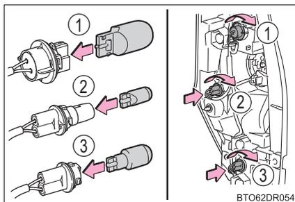
5 ランプ本体につながっているコネクターおよび配線を取り付け、ボルト 2 本でランプ本体を取り付ける
