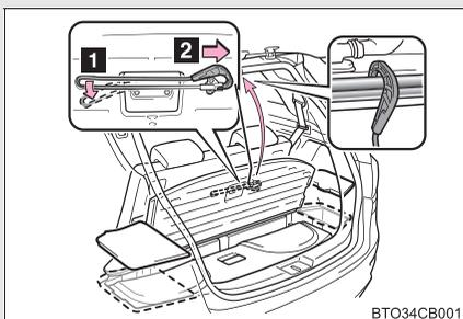
中央デッキボード裏側の格納部から固定フックをはずし、ラゲージルームの外枠にかけることができます。(5人乗り車を除く)
