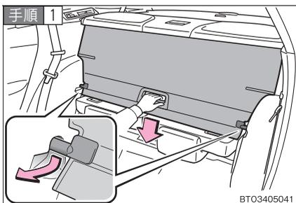
前カバー部を左右のホルダーからはずし、デュアルトノボードに格納する。
