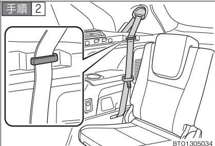
サードシート左右席シートベルトをシートベルトクリップに挟む。
