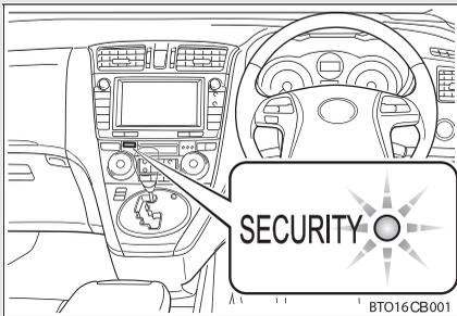
“エンジン スタートストップ”スイッチを OFF にすると、システムの作動を知らせるためにインジケーターが点滅します。
