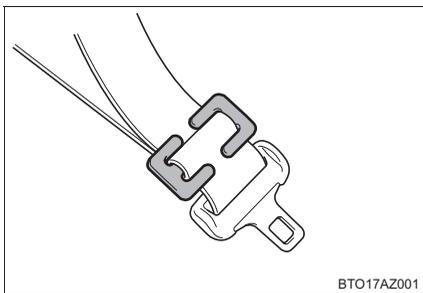
チャイルドシートにシートベルトの固定装置が備わっていない場合は、ロックングクリップ（別売）を使用して固定する。
