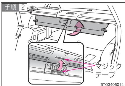
格納した前カバーをデュアルトノボードに固定する。
