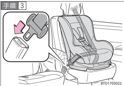
チャイルドシートにシートベルトを取りつけ、プレートをバックルに“カチッ”と音がするまで差し込む。ベルトがねじれていないようにする。
