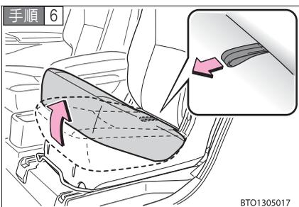
シートクッション後端のシートロック解除ベルトを前方へ引く。
