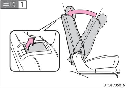
リクライニングレバーを引きながら、背もたれを一度前方に倒す。背もたれを立てて1段目の固定位置で固定する。
