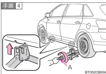
ジャッキの A 部を手で回して、ジャッキ溝をジャッキセット位置にしっかりかける。
