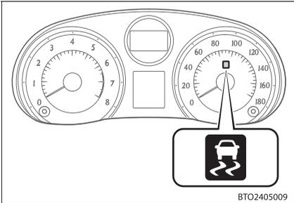
車両が横すべりしそうになったとき、前輪が空転したとき、ヒルスタートアシストコントロールを作動させ坂道発進をしたときは、VSC、TRC、ヒルスタートアシストコントロールの作動を表示するためにスリップ表示灯が点滅します。
