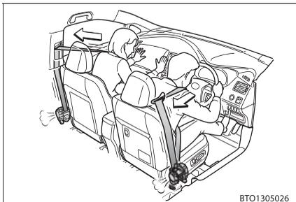
前方から強い衝突を受けたとき、シートベルトを引き込むことで適切な乗員拘束効果を確認します。
