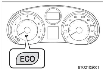
エコドライブインジケーターが点灯するとCO<sub>2</sub>（二酸化炭素）排出量の少ない運転をしていることをお知らせします。必要以上にアクセルペダルを踏むと消灯します。(Dで走行時)
