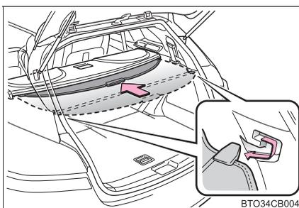
後カバー部を左右のホルダーからはずし、デュアルトノボードに格納する
