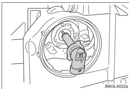
**5** 電球を取り付ける
