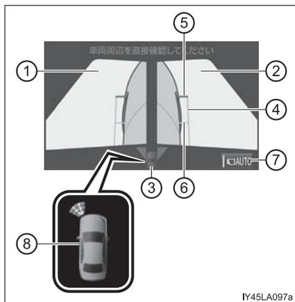
クリアランスソナーが On のとき、障害物の検知に従ってアイコンが割り込み表示されます。(クリアランスソナーについては、P. 272 を参照してください)
