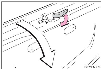
**パワーバックドアクローズスイッチ（パワーバックドア装着車）**
