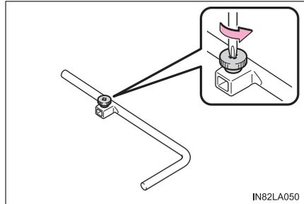
ジャッキハンドル、ジャッキハンドル延長バーを組み付け、ネジ部（1ヶ所）を締め付ける
