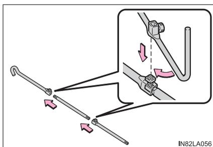
ジャッキハンドル延長バーとジャッキハンドルを組み付け、ネジ部（1ヶ所）を締め付ける
