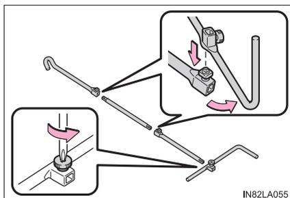
ジャッキハンドル延長バーとジャッキハンドルバーを組み付け、ボルト（2本）を締め付ける
