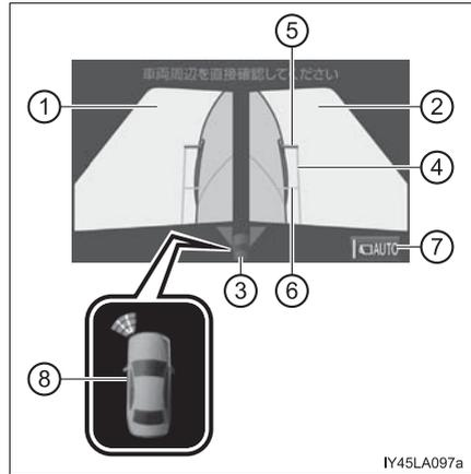
クリアランスソナーが On のとき、障害物の検知に従ってアイコンが割り込み表示されます。(クリアランスソナーについては、P. 270 を参照してください)
