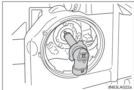
**5** 電球を取り付ける
