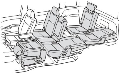
シートバックテーブル、セカンドシートとサードシートをフルリクライニングさせると、ベッドとしてくつろげるスペース、また長尺物を積むことができるスペースをつくることができます。
