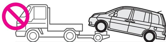
この速度、距離をこえてのけん引、または後進方向でのけん引をするとトランスミッションに悪影響をおよぼし、損傷するおそれがありますので、これらの場合は車両積載車などにより、4輪とも持ち上げて運搬してください。
