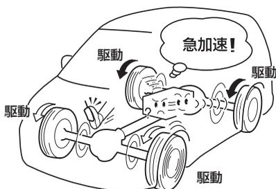
コーナリング時や登坂時、発進時、加速時、雪や雨などですべりやすい路面など様々な走行状態に応じて、最適な駆動力（トルク）を後輪へ配分し、FF走行から4WD走行までを自動的に制御します。
