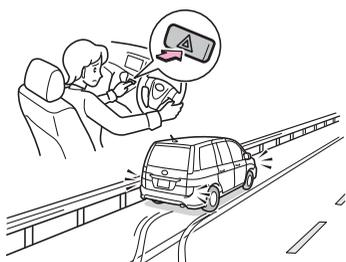
非常点滅灯（☉347ページの「非常点滅灯スイッチの使い方」参照）を点滅させながら、車を路肩に寄せ停車します。非常点滅灯は、故障などでやむを得ず、路上駐車する場合、他車に知らせるため使用します。
