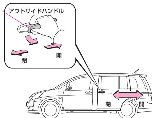
開けるときは、アウトサイドハンドルを引いてスライドドアを車両後方に操作します。
