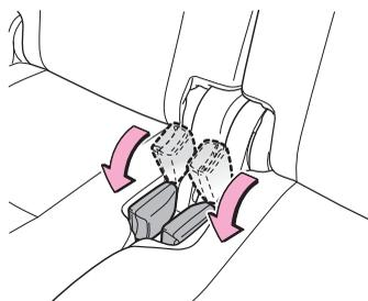
**2** シートベルトのバックルを収納します。
