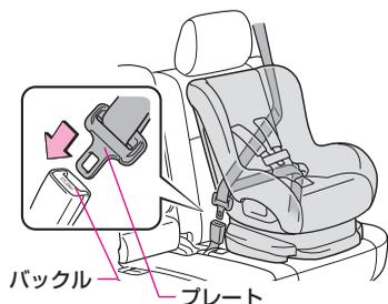
チャイルドシートにシートベルトを取りつけ、プレートをバックルに“カチッ”と音がするまで差し込みます。
