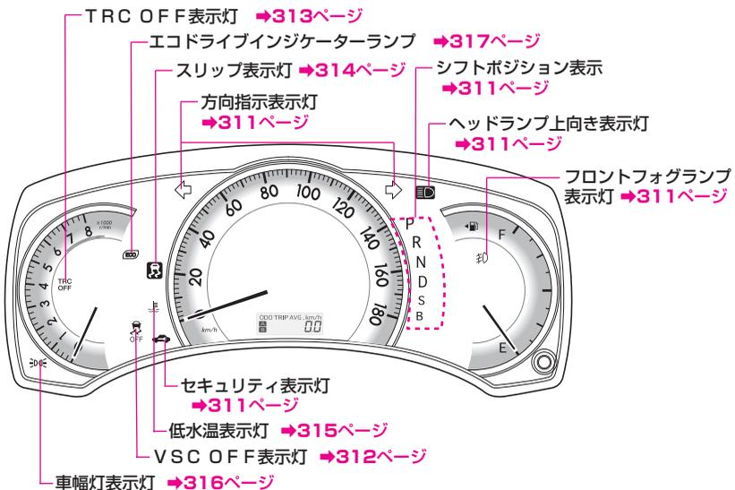
図ではすべてのグレードにおける警告灯を掲載しています。実際の車に設定される警告灯はグレード等により異なります。
