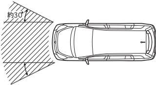
運転席・助手席SRSエアバッグは、車両前方左右約30°以内の方向から乗員に重大な傷害がおよぶような強い衝撃を受けたときに作動します。
