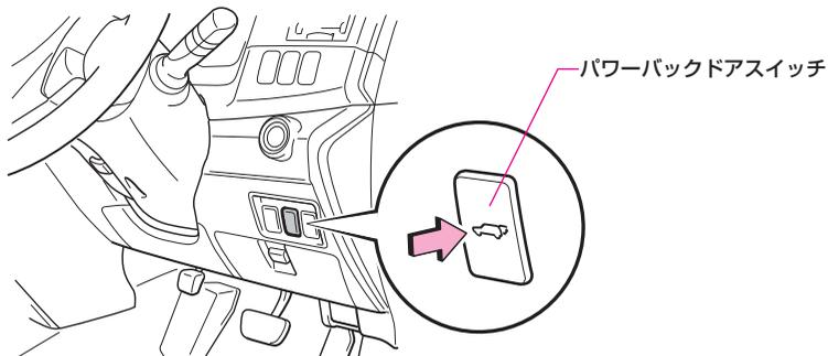
バックドアが全閉（全開）状態のときパワーバックドアスイッチを約1秒以上押し続けると、自動で全開（全閉）します。
