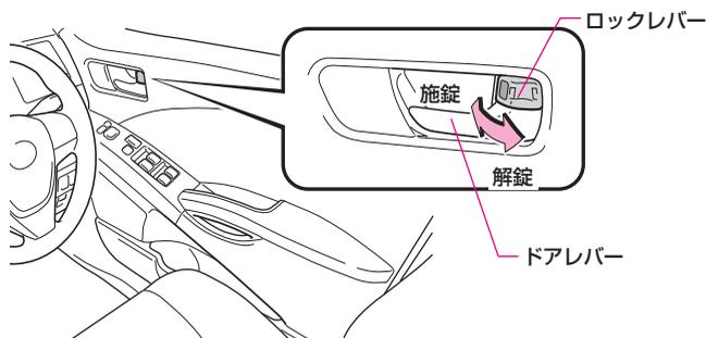
ロックレバーを前方に押し込むと施錠、後方に引き出すと解錠されます。
