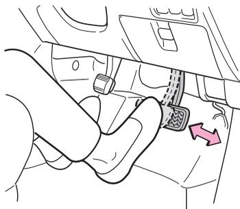
エンジンを始動し、ブレーキペダルをいっぱい踏み込み、床板とのすき間を点検します。併せてペダルの感触に異常がないかを点検します。
