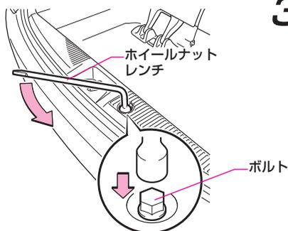
**3** ホイールナットレンチでボルトをゆるめます。
