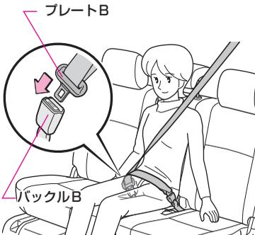
**4** プレートBを“カチッ”と音がするまでバックルBに差し込みます。
