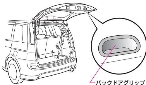
バックドアグリップを持ってバックドアをおろし、バックドア下端を押さえつけロックします。
