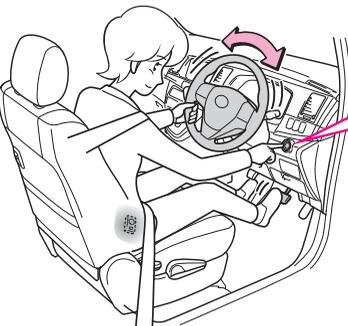
エンジン始動操作をしたときに、エンジンが始動せず“エンジンスタートストップ”スイッチの作動表示灯が緑色に点滅しているときは、ハンドルの負荷によりステアリングロックが解除されていません。
