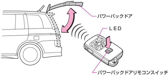
パワーバックドアが全閉（全開）状態のときパワーバックドアリモコンスイッチを約1秒以上押し続けると、自動で全開（全閉）します。
