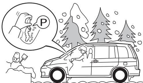
下り坂では前輪の前側、上り坂では後輪のうしろ側に輪止めをして、パーキングブレーキをかけず、シフトレバーをPにします。
