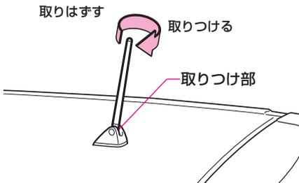
取りはずすときは、アンテナをまわして取り付け部から取りはずします。
