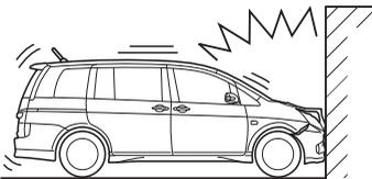
● 衝突時に変形、移動しないコンクリートのような固い壁に正面衝突したときであっても、衝突速度が約30km/h以下の場合
