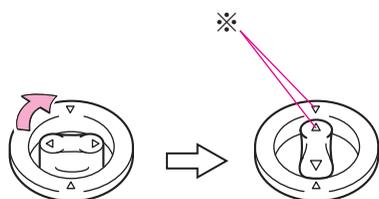
**2** 固定フック（クリップ）上部のレバーを回して、フロアマットを固定します。
