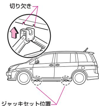
**6** ジャッキセット位置（切り欠きの間）にジャッキをかけます。
