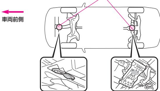
ガレージジャッキは、受皿の形状がガレージジャッキセット位置に適したサイズの受皿タイプを使用してください。
