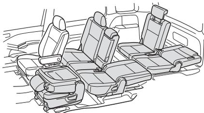
シートバックテーブル、セカンドシートとサードシートをフルリクライニングさせると、ベッドとしてくつろげるスペース、また長尺物を積むことができるスペースを作ることができます。
