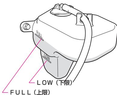
冷却水の量がリザーバータンクのFULL（上限）とLOW（下限）の間にあるかを点検します。
