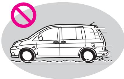
冠水した道路を走行するとエンストするだけでなく、電装品のショート、水を吸い込んでのエンジン破損など、重大な車両故障の原因となるおそれがあります。
