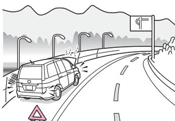
高速道路や自動車専用道路では、車両後方に停止表示板または停止表示灯を置いてください。（法的にも義務づけられています。）
