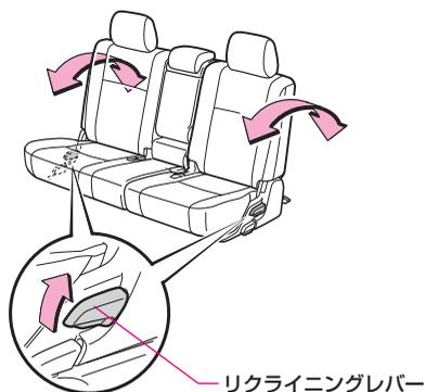
リクライニングレバー（上側）を引きながら、背もたれを前後に動かして調整します。調整後、シートを軽くゆさぶり確実に固定されていることを確認します。
