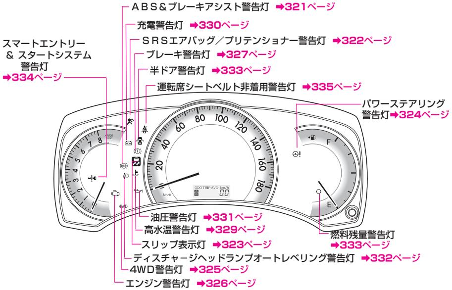
図ではすべてのグレードにおける警告灯を掲載しています。実際の車に設定される警告灯はグレード等により異なります。
