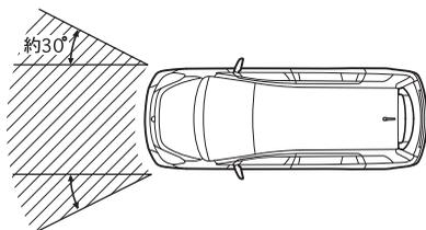
車両前方にグリルガードなどを装着すると、センサーが正常に衝撃を感知できなくなり、運転席・助手席SRSエアバッグの正常な作動を損なうおそれがあります。
