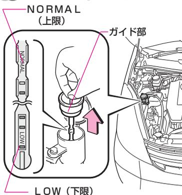
ウォッシャー液注入口のキャップを開け、液面がNORMAL（上限）とLOW（下限）の間にあることを、ガイド部についているレベルゲージで確認します。
