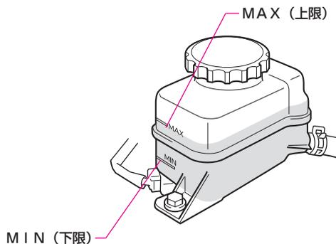
ブレーキフルードの量がリザーバータンクのMAX（上限）とMIN（下限）の間にあるかを点検します。
