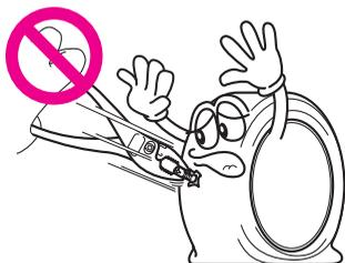
タイヤに刺さったクギやネジなどは取り除かずに応急修理してください。抜いてしまうと、タイヤパンク応急修理キットの補修液では応急修理が不可能になる場合があります。
