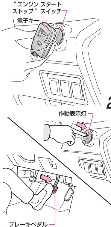
**1** ブレーキペダルをしっかりと踏みながら、電子キーのⓉ（トヨタマーク）のある面で“エンジン スタート ストップ” スイッチに触れます。
