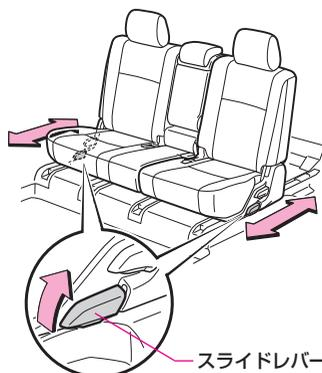
スライドレバー（下側）を引いたまま、シートを前後に動かして調整します。調整後、シートを軽くゆさぶり確実に固定されていることを確認します。
