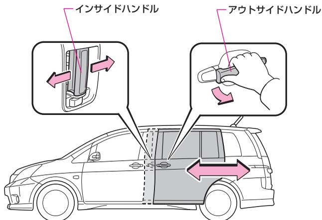
パワースライドドアが全閉状態のとき、ハンドルを操作してブザーが鳴る位置まで開けると、自動で全開します。また、パワースライドドアが全開状態のときハンドルを引くと、ブザーが鳴り自動で全閉します。閉作動中は、断続的にブザーが鳴ります。
