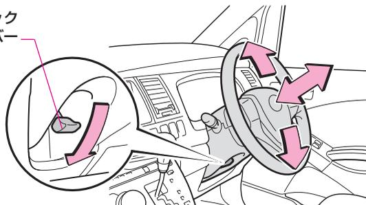
チルト&テレスコピックステアリングレバーを押し下げ、ハンドルを上下・前後に動かし適切な位置にして、チルト&テレスコピックステアリングレバーを引き上げると固定されます。
