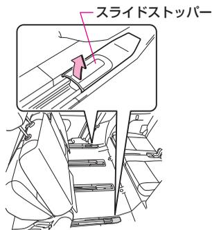
セカンドシートの左右シートレール後方にスライドストッパーが取り付けられています。セカンドシートを後方いっぱいまで移動させるときは、下記の手順で取りはずしてからセカンドシートを移動させてください。
