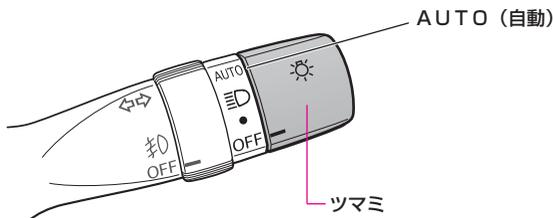
ツマミをAUTOにまわすと周囲の明るさに応じて、ヘッドランプ・車幅灯などが自動で点灯・消灯します。
