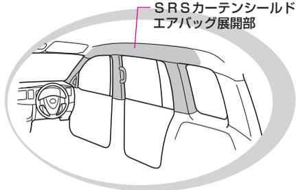
⑤ SRSエアバッグがふくらんだ直後は、SRSエアバッグ構成部品に触れないでください。
