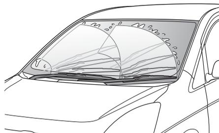
ウインドウウォッシャーでガラスをぬらした状態でワイパーを作動させ、「間欠作動」「低速作動」「高速作動」「一時作動」の各作動が良いか、拭き取り状態が良いか点検します。
