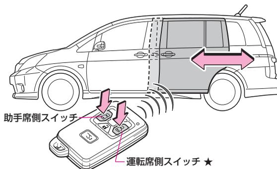
スライドドアが全閉（全開）状態のときパワースライドドアリモコンスイッチを約1秒以上押し続けると、自動で全開（全閉）します。
