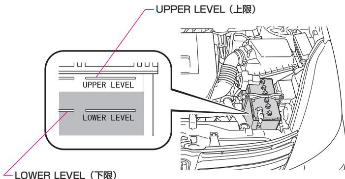
バッテリー液面が各液槽ともバッテリーのUPPER LEVEL（上限）と LOWER LEVEL（下限）の間にあるかを車両をゆするなどして点検します。
