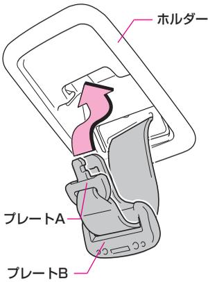
**2** プレートAとプレートBを重ねて、ホルダーに格納します。
