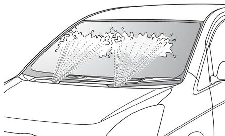
エンジンを始動し、ウインドウウォッシャーを作動させ、噴射状態を点検します。
