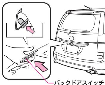
バックドアスイッチを押したまま、バックドアを持ち上げます。
