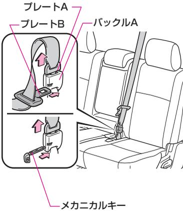
**1** プレートBなどでバックルAのボタンを押し、プレートAを分離します。
