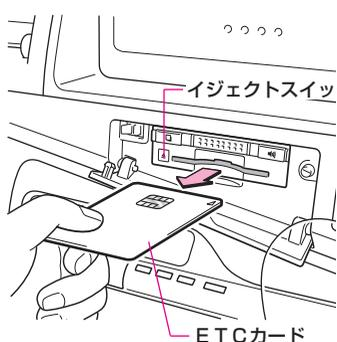
1 安全な場所に停車し、エンジンを停止する前にETCユニットのイジェクトスイッチを押します。
