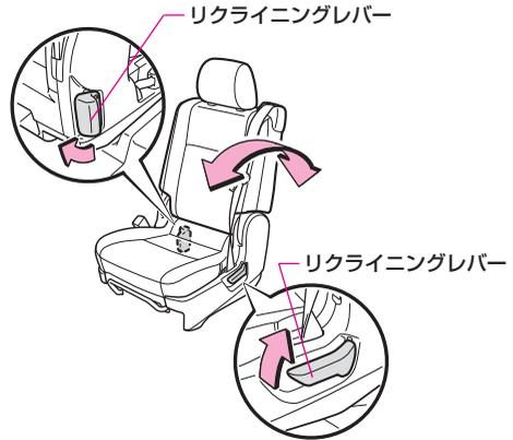
リクライニングレバーを引いたまま、背もたれを前後に動かして調整します。調整後、シートを軽くゆさぶり確実に固定されていることを確認します。
