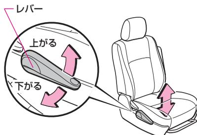
シートを上げるときは上に、下げるときは下にレバーを動かして調整します。
