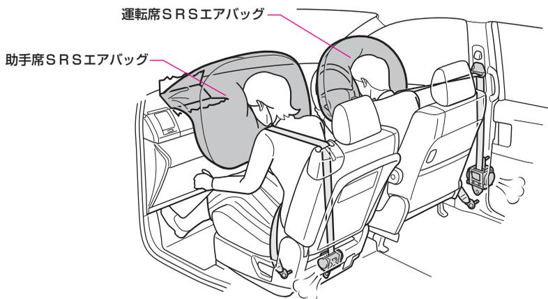
※ Supplemental Restraint Systemの略で「乗員保護補助装置」の意味。
