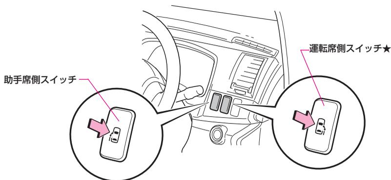
パワースライドドアが全閉（全開）状態のとき、パワースライドドアスイッチを約1秒以上押し続けると、自動で全開（全閉）します。
