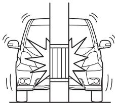
● 衝突時に変形、移動しない電柱や立木などの狭い範囲に正面衝突したときであっても、衝突速度が約35km/h以下の場合
