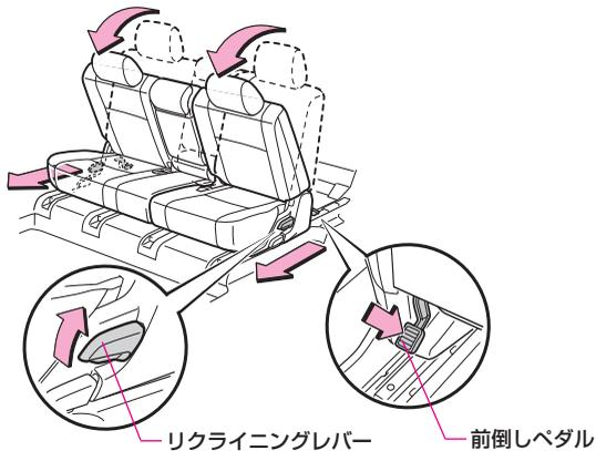
リクライニングレバーを引き上げるか、またはシートうしろ側の前倒しペダルを踏み込むと、背もたれが自動的に前に倒れます。
