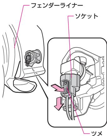
**2** ツメを押して電球からソケットを取りはずします。
