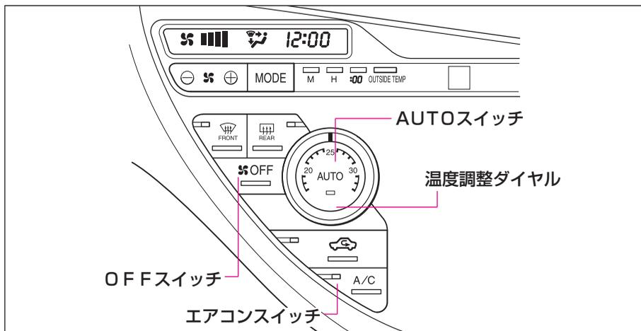
AUTOスイッチを押すと、ファンが作動し、吹き出し口・風量が自動的に調整され設定温度となります。
