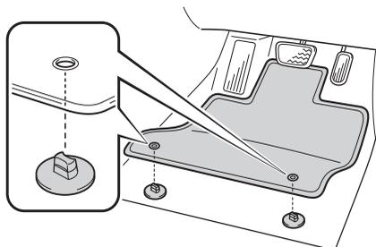
**1** 固定フック（クリップ）にフロアマット取り付け穴をはめ込みます。
