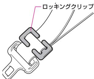
チャイルドシートにシートベルトの固定装置が備わっていない場合は、ロックングクリップ（別売）を使用して固定します。
