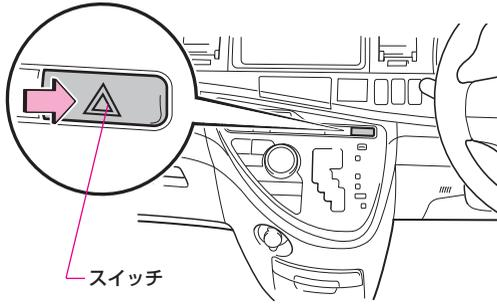
スイッチを押すとすべての方向指示燈が点滅し、点滅中にもう一度押すと消灯します。
