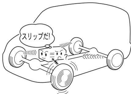
タイヤのスリップは4輪に取りつけられたセンサーからの信号を比較し、いずれかの信号のみほかの車輪より多い場合、スリップしているとコンピューターが判断します。それによって、スリップしているタイヤの駆動力を抑えようとブレーキをかけたり、エンジンの出力を一時的に抑えたりして、スリップを抑制させます。
