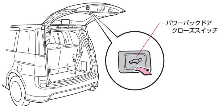
バックドアが全開状態のときパワーバックドアクローズスイッチを押すと、バックドアが自動で閉まります。
