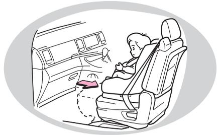
■ISOFIX対応チャイルドシート固定専用バー&トップテザーアンカーで固定する子供専用シート（チャイルドシート・ベビーシート）を取りつけるときは、固定専用バーおよびトップテザーアンカー周辺に異物がないこと、シートベルトなどのかみ込みがないことを確認してください。
