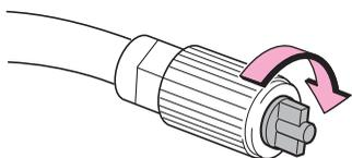
**16** バルブキャップを応急修理したタイヤのバルブに取り付けます。
