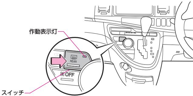
スイッチを押すと約15分間作動し、作動中にもう一度押すと停止します。
