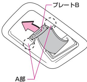
分離格納式シートベルトを使用するときは、必ずプレートAとバックルAを結合してください。結合しない状態で使用すると、シートベルトが十分な効果を発揮せず、重大な傷害におよぶか、最悪の場合死亡につながるおそれがあります。
