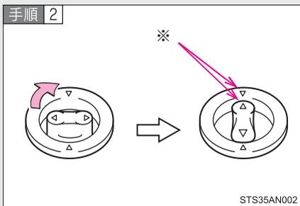
固定フック（クリップ）上部のレバーをまわして、フロアマットを固定する
