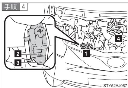
冷却水の量がリザーバタンクの“FULL”（上限）と“LOW”（下限）のあいだにあるかを点検する
