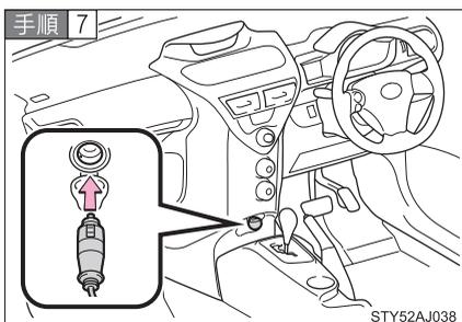
コンプレッサーの電源プラグをアクセサリソケットに挿し込む。
