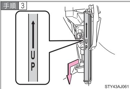
フィルターを取りはずし、新しいフィルターに交換する。
