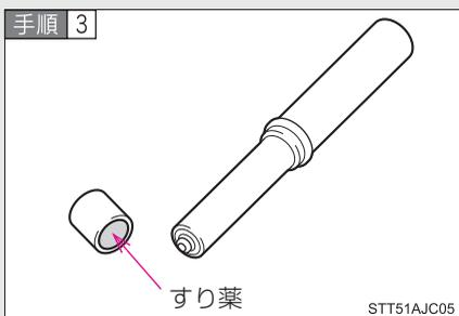
先端のフタをとり、すり薬と発炎筒の先端をこすり、着火させる。
