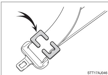
チャイルドシートにシートベルトの固定装置が備わっていない場合は、ロッキングクリップ（別売）を使用して固定する。
