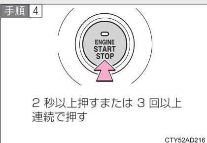
スマートエントリー&スタートシステム装着車：“エンジンスタートストップ”スイッチを2秒以上押し続けるか、素早く3回以上連続で押してエンジンを停止する。
