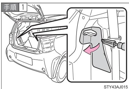
バックドアを開けて、図の位置にマイナスドライバーを挿し込んで、カバーを取りはずす。
