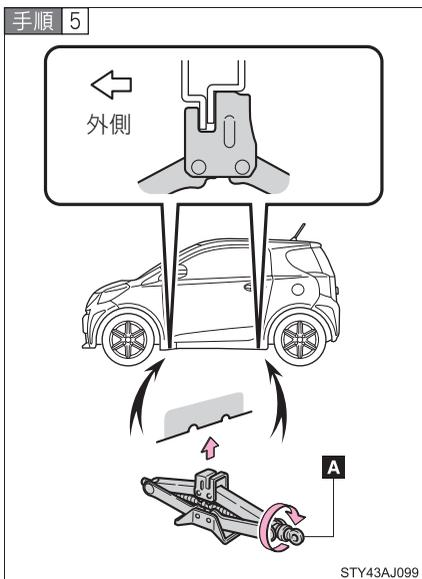
ジャッキの A 部を手でまわして、ジャッキ溝をジャッキセット位置にしっかりかける。
