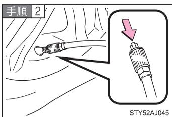
ボトルのホース先端に空気逃がしキャップをかぶせ、キャップの突起部をタイヤのバルブに押しあて、空気を抜く。
