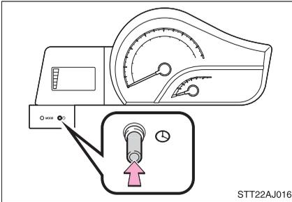
**手順 1** クロックセットボタンを押し続けて、分表示を点滅させる。
