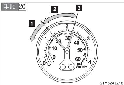
コンプレッサーのスイッチを数秒間 ON にし、OFF にしてから空気圧を確認する。
