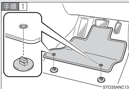
固定フック（クリップ）にフロアマット取り付け穴をはめ込む
