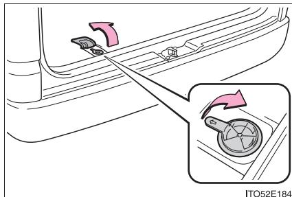
**2 ホイールナットレンチを使って、スペアタイヤ格納具がフックからはずせる程度にボルトをゆるめる**
