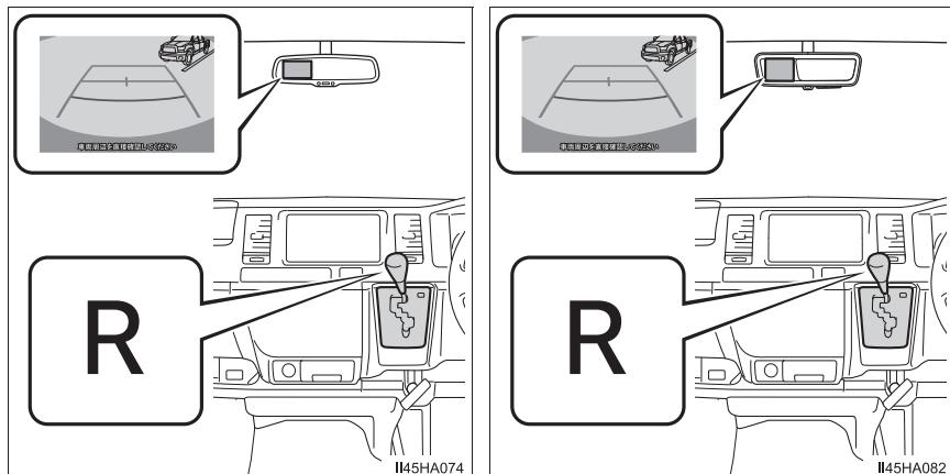
エンジンスイッチが“ON”（スマートエントリー＆スタートシステム非装着車）またはイグニッションONモード（スマートエントリー＆スタートシステム装着車）のとき、シフトレバーをRになると、バックモニターの画面が表示されます。
