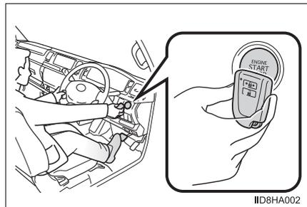
③ ブレーキペダルをしっかりと踏み込んで、マルチインフォメーションディスプレイに
