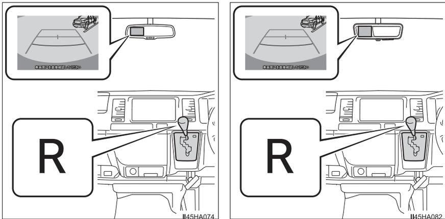
エンジンスイッチが“ON”（スマートエントリー&スタートシステム非装着車）、またはイグニッションONモード（スマートエントリー&スタートシステム装着車）のとき、シフトレバーをRにすると、バックモニターの画面が表示されます。
