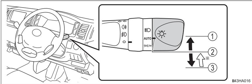
※ スイッチを③  $\text{OFF/O}$  の位置へ操作し手を離すと、自動的に②  $\text{AUTO}$  の位置へ戻ります。
