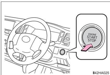
ディーゼル車：
