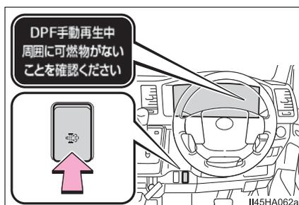
※<sup>1</sup> 状況により、エンジン回転数が 3000rpm になるまでアクセルペダルを踏み込む必要があります。エンジン冷却水、または排出ガスの温度が低いと、燃焼（再生）処理に時間がかかったり、燃焼（再生）処理ができなかったりする場合があります。
