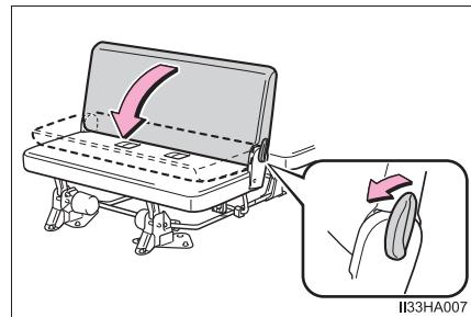
4 左右いずれかのロック解除レバーを引いて、シート後脚部のロックを解除し、セカンドシートを前方に起こす
