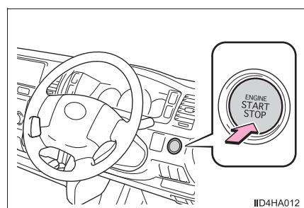
ディーゼル車： (予熱表示灯) が点灯後消灯したらエンジンが始動します。
