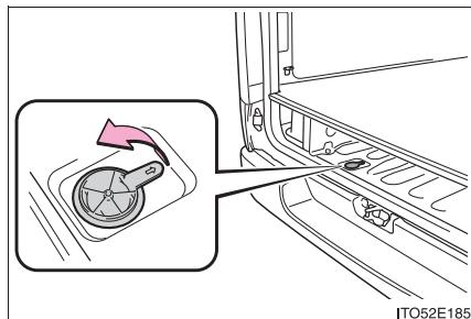
マットの切り欠き部分をめくり、 床下収納（→ P. 287）のカバーをはずして、 キャップをはずす
