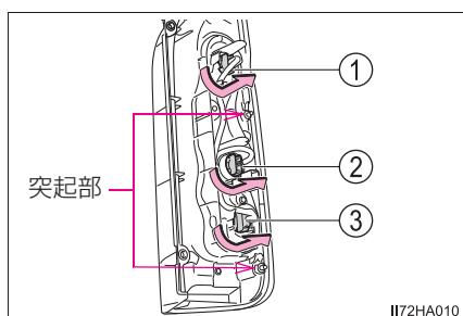
**[5] 電球を取りはずし、新しい電球を取り付ける**
