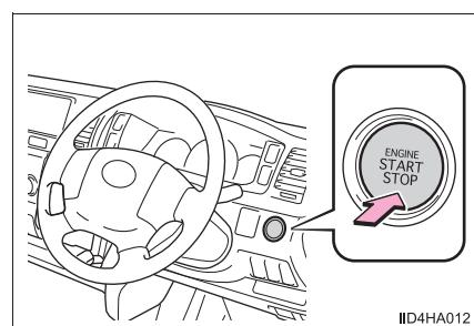
ディーゼル車：
