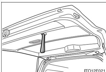
バックドアを閉めるときは、バックドアストラップを持ってバックドアを引き下げ、必ず外から押して閉めてください。
