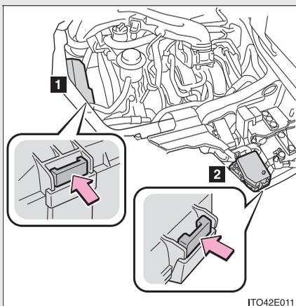
エンジン点検口 (→P. 292) を開けて、ツメを押しながら、カバーを持ち上げる
