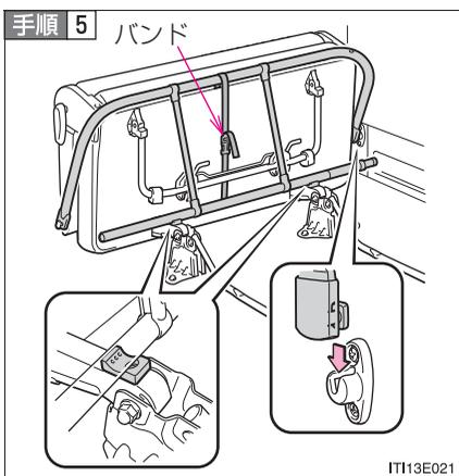
セパレーターバー (Dタイプ:→P. 74) を取りはずし、図のように格納する
