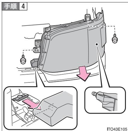
ネジ (2 本) をはずし、ヘッドライト本体を手前に引いて各部の固定はずす
