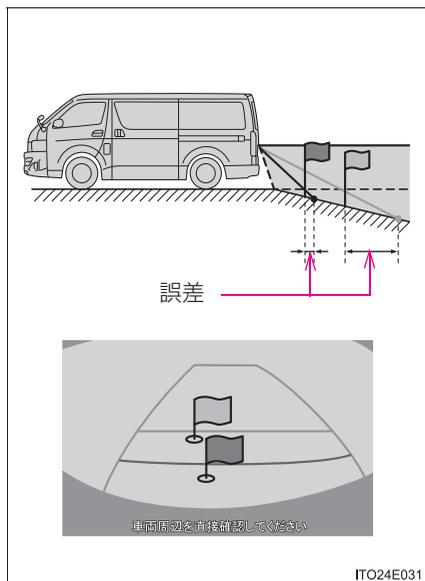
実際の距離よりうしろに距離目安線が表示されます。そのため、下り坂にある障害物は、実際より近くに見えます。同様にガイド線と実際の路面上の進路にも誤差が生じます。
