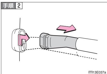
セパレーターバーの取り付け部(運転席側)を引き上げ、内側に縮める
