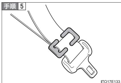
チャイルドシートにシートベルトの固定機構が備わっていない場合は、ロックングクリップ（別売）を使用して固定する
