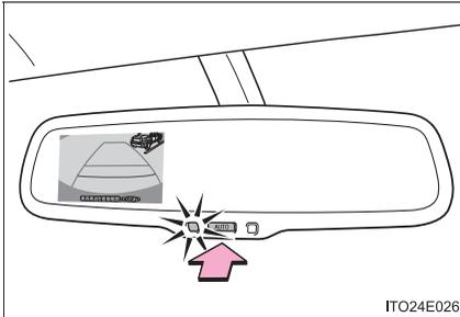
バックモニターの画面が表示されているとき、インナーミラーの AUTO ボタンを押して、画面の ON モードと OFF モードを切り替えることができます。
