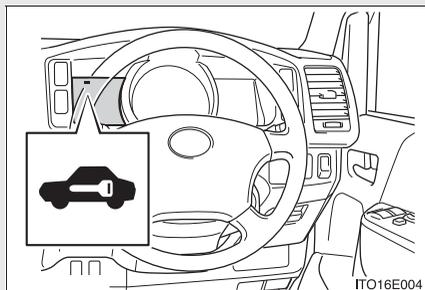
キーをエンジン スイッチから抜くと、システムの作動を知らせるためにインジケーターが点滅します。
