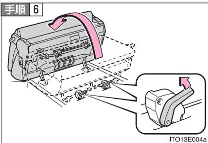
左右いずれかのロック解除レバーを引いて、シート脚部のロックを解除し、リヤシート全体を前方に起こす
