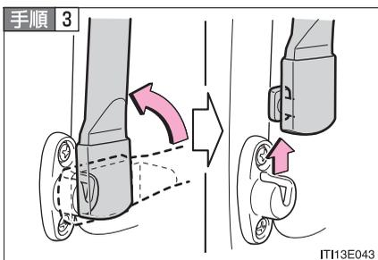
下側のセパレーターバー取り付け部をブラケットから取りはずす
