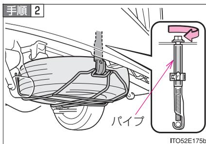
パイプががたつかなくなるまでboltを締め付けたあと、さらに1/4回転以上締め付ける
