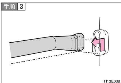
セパレーターバーの取り付け部(助手席側)を引き上げ、セパレーターバーを取りはずす
