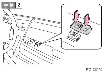
シフトレバーを P または N に入れ、ドアロックスイッチの LOCK 側または UNLOCK 側を約 5 秒間押し続けて離す
