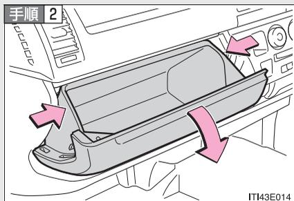
グローブボックスを開き、グローブボックス側面を内側に押し、上部のツメを片側ずつはずし、下部のツメははずして取りはずす
