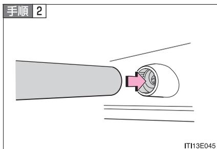
上側のセパレーターバー取り付け部（助手席側）をブラケットに挿し込む
