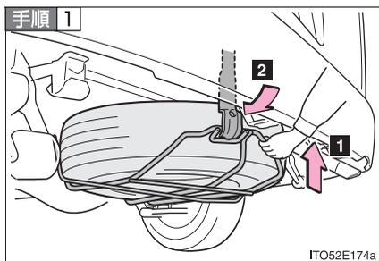
スペアタイヤ格納具にタイヤを載せて持ち上げ（**1**）、フックをかけてboltを締め付ける（**2**）
