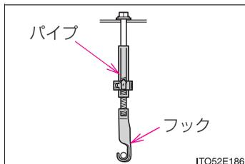
スペアタイヤ格納具を降ろす際に、ボルトをゆるめすぎてフックが脱落した場合は、パイプが入っているのを確認してから図のようにフックを取り付けてください。
