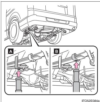
路面状況などにより、**A** の位置にジャッキをセットできないときは、**B** の位置でジャッキアップしてください。
