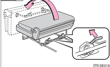
左右いずれかのロック解除レバーを引いて、シート脚部のロックを解除し、1 列目リヤシートを前方に起こす
