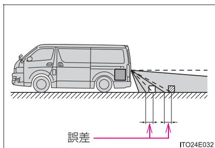
乗車人数、積載量などにより車が傾いているときは、実際の距離、進路と誤差が生じます。
