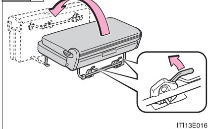
左右いずれかのロック解除レバーを引いて、シート脚部のロックを解除し、リヤシート全体を前方に起こす
