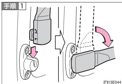
下側のセパレーターバー取り付け部をブラケットに挿し込み、前方または後方に倒す
