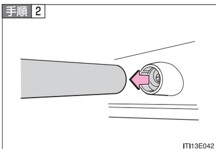
上側のセパレーターバー取り付け部（助手席側）をブラケットから取りはずす
