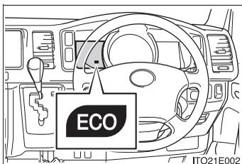
環境に配慮した運転をしているとき、エコドライブインジケータランプが点灯します。必要以上にアクセルペダルを踏んだときや停車中は消灯します。
