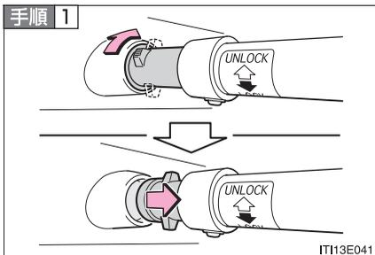
上側のセパレーターバー取り付け部（運転席側）をブラケットから取りはずす
