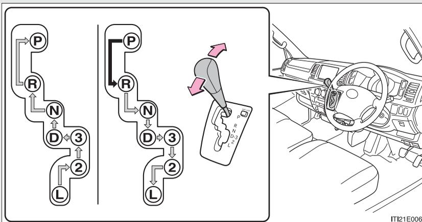
← エンジン スイッチが “ ON ” の状態で、ブレーキペダルを踏んだまま操作します。
