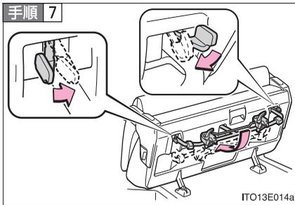
左右のレバーを内側に引いてロックを解除し、シート脚部を折りたたむ
