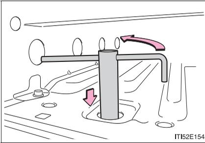
スペアタイヤレンチを使って、スペアタイヤ格納具がフックからはずせる程度にボルトをゆるめる
