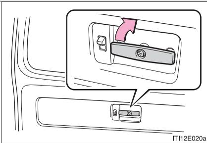
バックドアハンドルを右にまわして、バックドアを押し上げる
