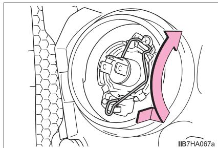
**8** 電球を取りはずす
