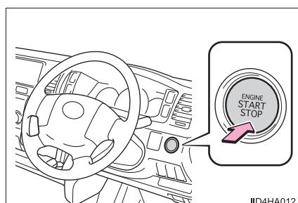
ディーゼル車：
