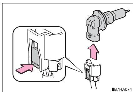
④ 電球を交換し、ソケットを取り付ける
