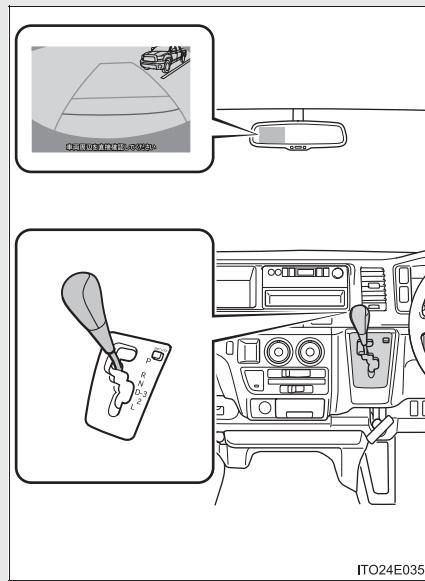
エンジンスイッチが“ON”のとき、シフトレバーをRになると、バックモニターの画面が表示されます。
