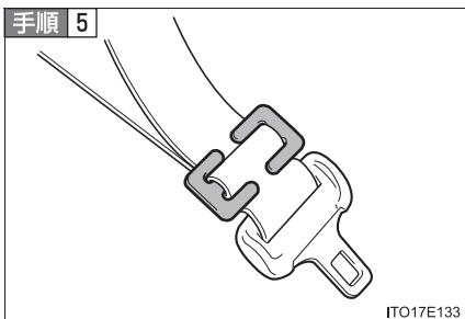
チャイルドシートにシートベルトの固定機構が備わっていない場合は、ロッキングクリップ（別売）を使用して固定する
