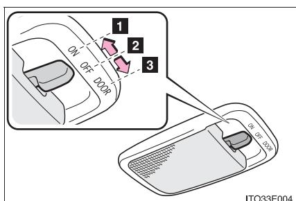
**1** メインスイッチのON/OFFに連動して、ライトの点灯・消灯を切りかえる
