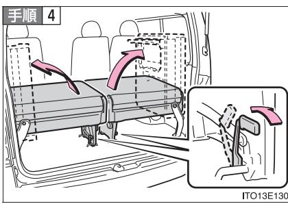
ロック解除レバーを動かしてシート脚部のロックを解除し、シート全体を窓側に起こす
