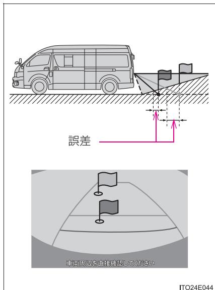
実際の距離より手前に距離目安線が表示されます。そのため、上り坂にある障害物は実際より遠くにあるように見えます。同様にガイド線と実際の路面上の進路にも誤差が生じます。
