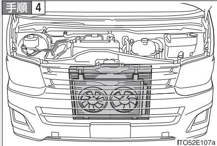
エンジンが十分に冷えてから、冷却水の量やラジエーターコア部（放熱部）の冷却水もれを点検する
