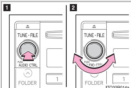
1 TUNE・FILE PUSH AUDIO CTRL を押して、調整したいモードを表示させる
