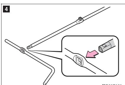
4 ジャッキハンドル延長用バーをジャッキハンドルの穴部に確実に挿し込む
