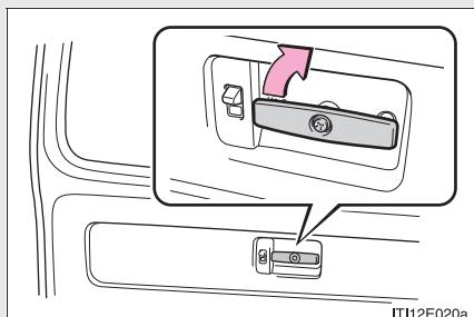
バックドアハンドルを右にまわして、バックドアを押し上げる
