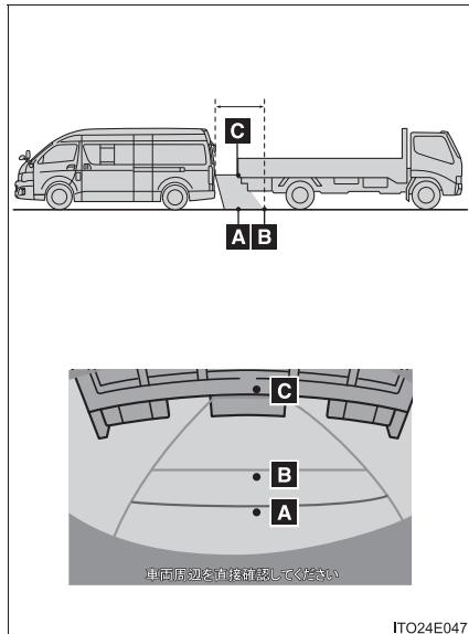
後方や周囲の安全を直接確認してください。画面では、距離目安線により B の位置にトラックが駐車してあるように見えますが、実際には A の位置まで後退すると、ぶつかります。画面では A、B、C の順に近く見えますが、実際の距離は A と C は同じ距離で、B は A と C より遠い距離にあります。
