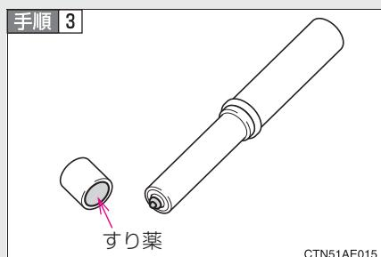
先端のフタを取り、すり薬と発炎筒の先端をこすり、着火させる
