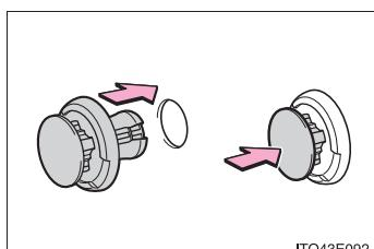
クリップを穴に挿し込み、中央部を押し込む
