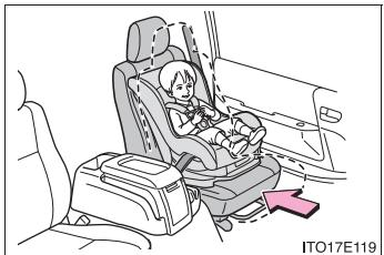
● 助手席の前後位置調整が可能な車両の場合、助手席に前向きにチャイルドシートを取り付けるときには、助手席シートをいちばんうしろに下げて取り付けてください。
