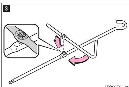
3 ジャッキハンドルの穴部を使い、接続用ボルトを締め付ける
