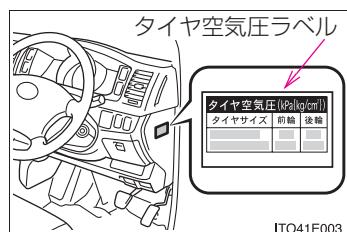
タイヤの指定空気圧は、インストルメントパネル横（運転席側）のタイヤ空気圧ラベルで確認することができます。
