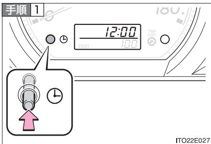
時間調整ボタンを押し続けて、時刻表示を点滅させる
