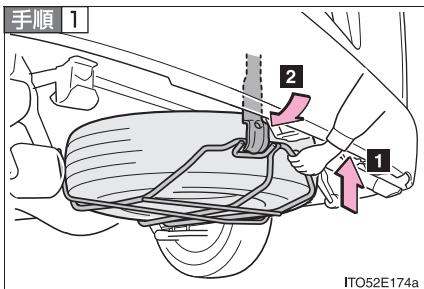
スペアタイヤ格納具にタイヤを載せて持ち上げ（1）、フックをかけてボルトを締め付ける（2）
