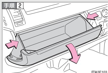
グローブボックスを開き、グローブボックス側面を内側に押して上部のツメを片側ずつはずし、下部のツメをはずして取りはずす
