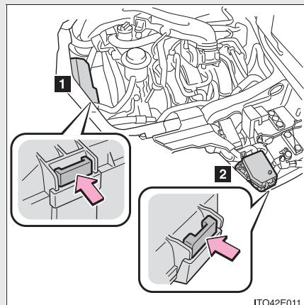
エンジン点検口(→P. 249)を開けて、ツメを押しながら、カバーを持ち上げる
