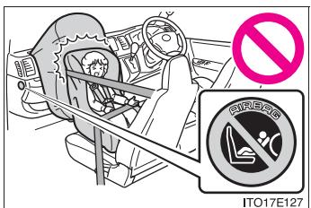
● 助手席には、チャイルドシートをうしろ向きに取り付けないでください。うしろ向きに取り付けていると、事故などで助手席SRSエアバッグがふくらんだとき、重大な傷害におよぶか、最悪の場合死亡につながるおそれがあります。
