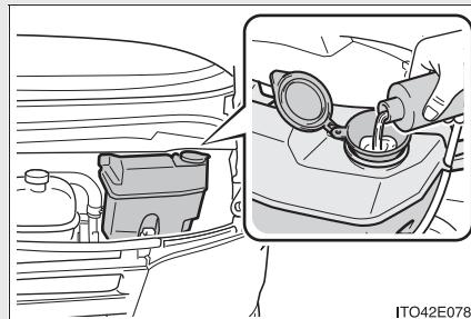
タンク側面から液量を確認し、不足しているときは、キャップを開けてウォッシャー液を補給する
