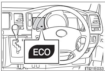
環境に配慮した運転をしているとき、エコドライブインジケーターランプが点灯します。必要以上にアクセルペダルを踏んだときや停車中は消灯します。
