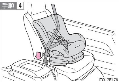
チャイルドシートにシートベルトを取り付け、プレートをバックルに“カチッ”と音がするまで挿し込む。ベルトがねじれていないうにする
