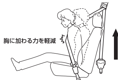
【衝突時規定荷重を維持しながらシートベルトを引き出す】
