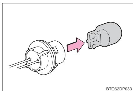
**5 新しい電球を取り付け、ソケットをランプ本体に挿し込み右にまわして取り付ける**
