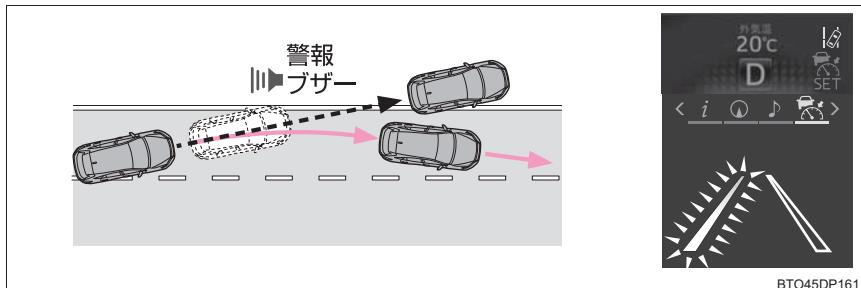
車線から逸脱する可能性があるとシステムが判断した場合に、警告ブザーが「ピピピピ」と鳴り、マルチインフォメーションディスプレイの表示により注意をうながします。
