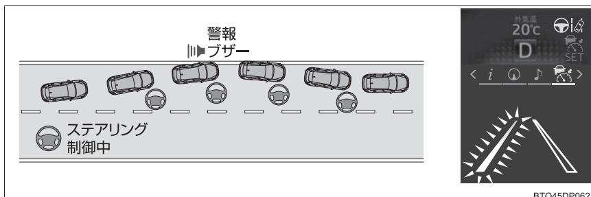
車線から逸脱する可能性があるとシステムが判断した場合に、マルチインフォメーションディスプレイ表示および、ハンドルへの操舵力支援を行い、車線逸脱の回避に必要なハンドル操作の一部をアシストします。
