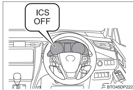
OFF（停止）に切りかえて、インテリジェントクリアラנסソナーを停止させた場合、再度、マルチインフォメーションディスプレイの「設定」から「ICS」を ON（作動）に切りかえないとシステムは復帰しません。
