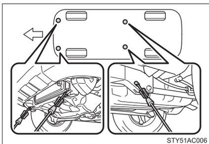
車両運搬車で輸送するときは、図の場所で固縛する
