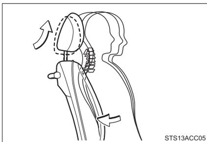
追突の衝撃によって、乗員の腰がシートバックを押すことでヘッドレストが少し斜め上方に動き乗員のむち打ち傷害軽減に貢献します。
