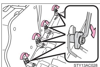
工具を使用し、ボルトを締める
