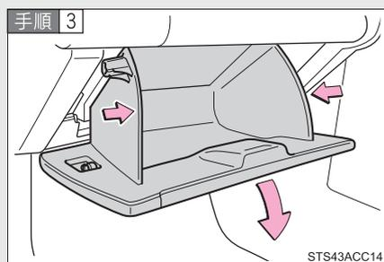
グローブボックスの側面を内側に押し、たわませながら上部のツメを片側ずつはずす
