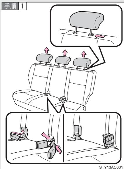
ヘッドレストをはずし、シートベルトのバックルを格納する
