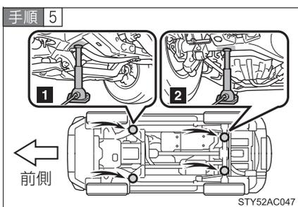
組み付けたジャッキハンドルをジャッキ穴部に挿し込みジャッキセット位置にジャッキをかける
