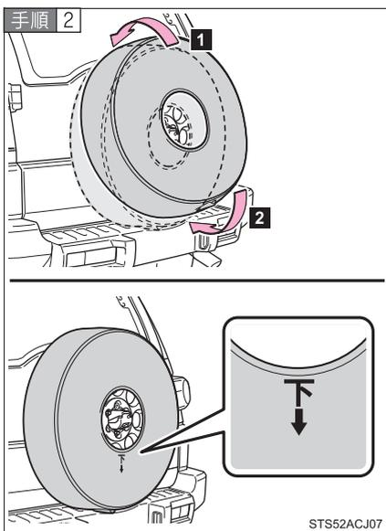
タイヤの上側面からスペアタイヤカバーをかぶせて取り付ける
