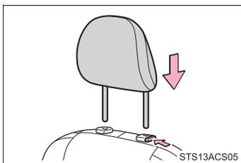
ヘッドレストを取り付け穴に合わせて、ロック位置まで押し下げてください。
