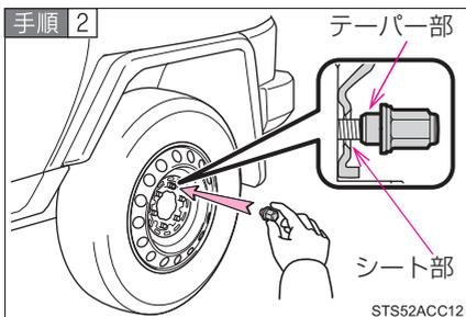
タイヤを取り付け、タイヤががたつかない程度まで手でナットを仮締めする
