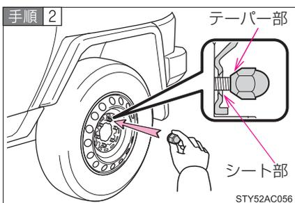
タイヤを取り付け、タイヤががたつかない程度まで手でナットを仮締めする
