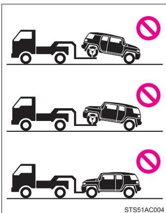
4輪とも持ち上げた状態で運搬してください。タイヤが地面に着いた状態でけん引すると、駆動系部品が破損したり車が台車から飛び出したりするおそれがあります。
