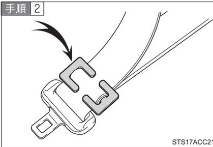
チャイルドシートにシートベルトの固定装置が備っていない場合は、ロックングクリップ（別売）を使用して固定する
