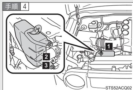
冷却水の量がリザーバータンクの F (上限) と L (下限) の間にあるかを点検する
