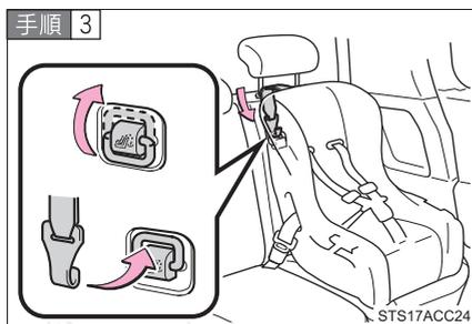
トップテザーアンカーを上げて、アンカーにフックを固定し、テザーベルトを締める
