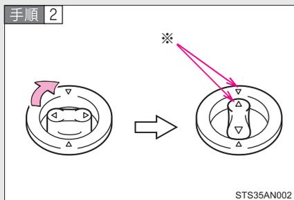
固定フック（クリップ）上部のレバーをまわして、フロアマットを固定する
