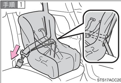
チャイルドシートにシートベルトを取り付け、プレートをバックルに“カチッ”と音がするまで押し込む。ベルトがねじれていないようにする
