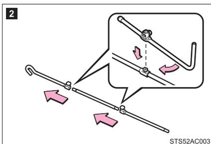
2 ジャッキハンドル延長バーとジャッキハンドルバーを組み付け、ボルト (2 本) を締め付けるボルトがしっかりと固定されていることを確認します。
