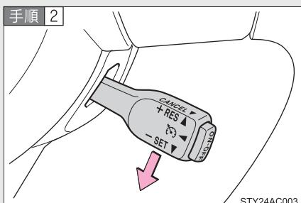
希望の速度まで加速／減速し、レバーを下げるで設定する
