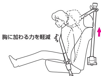
【衝突時規定荷重を維持しながらシートベルトを引き出す】
