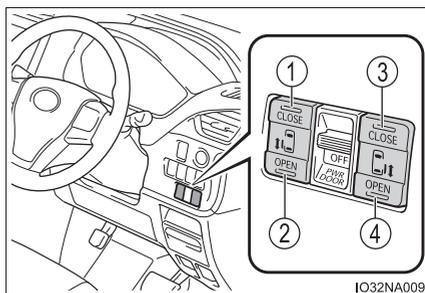
開閉作動中に再度スイッチを押すと、作動が停止します。
