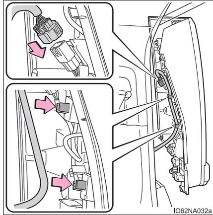
**10** 車体の取り付け部にピンを合わせてランプ本体を取り付け、ボルト（2個）で固定する
