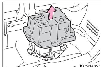
補機バッテリーの点検・交換後は、必ずもとどおりにカバーを取り付けてください。
