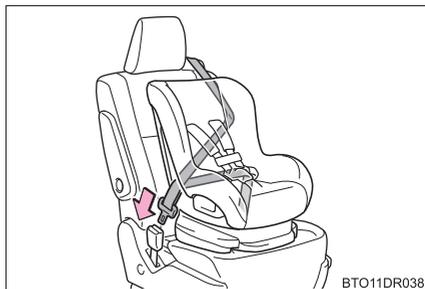
4 チャイルドシートにシートベルトの固定装置が備わっていない場合は、ロックングクリップ (別売) を使用して固定する
