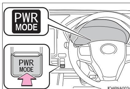
※ エコドライブモード・パワーモードともに解除された状態のときは、通常の走行に適した通常走行モードになります。
