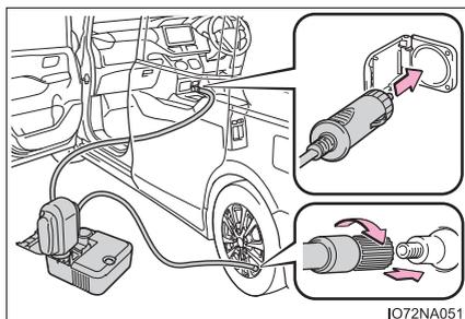
**21** コンプレッサーのスイッチを約 5 秒間 ON にし、OFF にして空気圧を確認する
