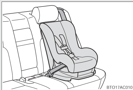
シートベルトによる取り付け
