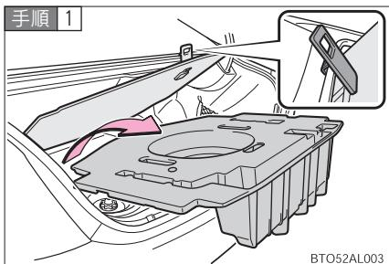
ラゲージマットを持ち上げ、レバーをトランクの縁にかけておき、ラゲージアンダートレイを取りはずす
