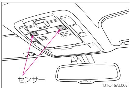
侵入センサーは、車内に不正に入り込んだ侵入者の動きを超音波で検知するセンサーです。侵入者の動きで検知するため、ドアを開けずガラスを割って入り込んだ侵入者なども検知できます。
