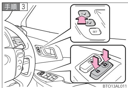
呼び出したポジションのボタンを押しながら、ドアロックスイッチの解錠側または施錠側をブザーが鳴るまで押す
