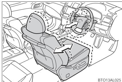
降車時：ハンドルが最上段、最前方に移動、運転席シートが後方に移動（オートアウェイ機能）
