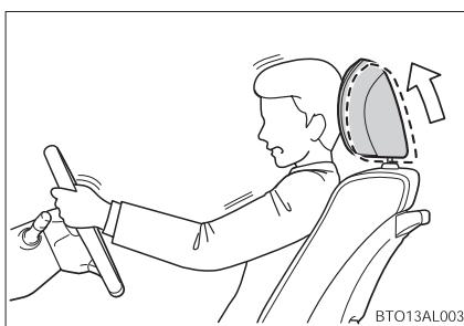
追突された際、乗員の腰が背もたれを押すことで内蔵された機構が作動し、ヘッドレストが少し斜め上方に動きます。
