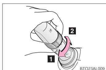
● ツマミを回すとセンサーの感度が調整できます。
