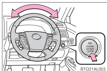
マルチインフォメーションディスプレイにメッセージが表示され、“エンジン スタート ストップ”スイッチ上のインジケーターが緑色に点滅します。ステアリングを左右に動かしながら、“エンジン スタート ストップ”スイッチを押してください。
