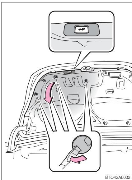
パワートランクリッド装着車は、助手席側の電球を交換する場合、パワートランクリッドスイッチのスイッチカバーも取りはずします。
