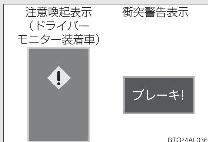
衝突の可能性があると判断したとき、“ピーピーピー”とブザー音が鳴り、PCS 警告灯が点滅し、マルチインフォメーションディスプレイに注意喚起表示が出ます。さらに衝突の可能性が高い場合には、“ビビビ…”とブザー音が鳴り、PCS 警告灯が点滅、衝突警告表示を出し、回避操作をうながします。プリクラッシュブレーキ OFF スイッチを使って ON/OFF の切りかえができます。
