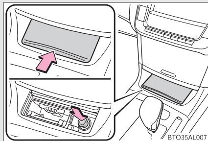
フタを押して開けて、シガレットライターを押し込む
