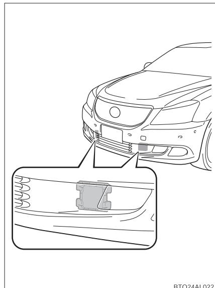
レーダーセンサーにより、走行中に斜め前方に車があるかどうかを検知し、その位置や車速、進路から衝突するおそれがあるかどうか判断します。
