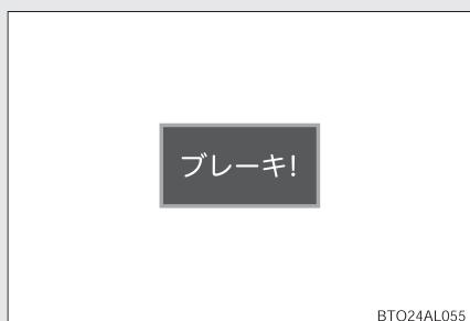
衝突の可能性が高いとき、“ピピピピ…”とブザー音が鳴り、PCS 警告灯が点滅、マルチインフォメーションディスプレイに衝突警告表示を出し、回避操作をうながします。プリクラッシュブレーキ OFF スイッチを使って ON/OFF の切りかえができます。（→P. 221, 230）
