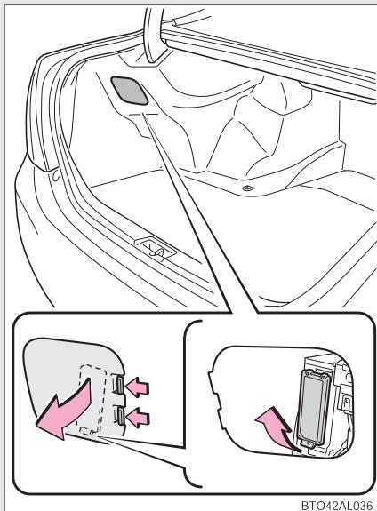
トランクを開け、カバーを取りはずし、ヒューズボックスカバーを取りはずす
