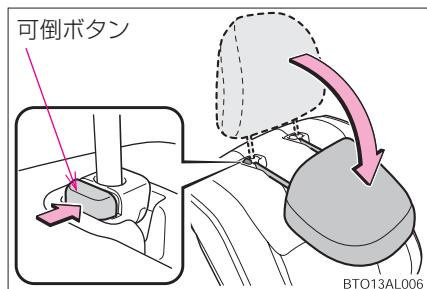
ヘッドラストをいちばん上まで引き上げたあと、可倒ボタンを押して、さらに引き上げ、ヘッドラストを前に倒します。
