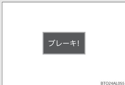
衝突の可能性が高いとき、「ピピピ…」とブザー音が鳴り、PCS 警告灯が点滅、マルチインフォメーションディスプレイに衝突警告表示を出し、回避操作をうながします。プリクラッシュブレーキ OFF スイッチを使って ON/OFF の切りかえができます。(→P. 221, 230)
