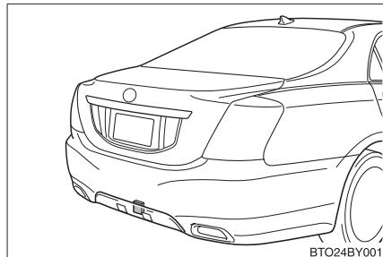
レーダーセンサーにより、後方から接近する車を検知し、その位置や速度、進路から追突する可能性を事前に判断します。
