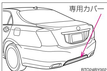
後方ブリクラッシュセーフティシステム装着車の専用カバーは、レーダーセンサーの電波透過性に影響します。システムが効果を発揮できるように次のことをお守りください。
