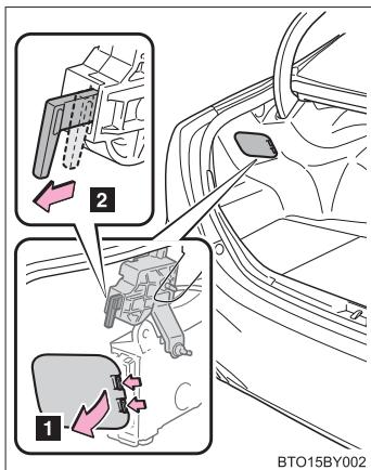
車内のスイッチを押しても給油口が開かないときは、トランク内にあるカバーを取りはずし（①）、その穴の上側にあるレバーを引きます（②）。
